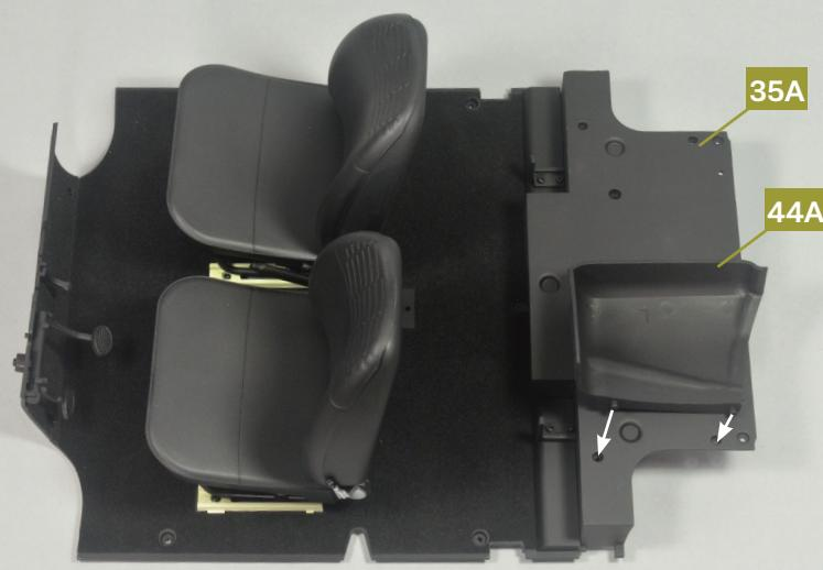
Setzen Sie die linke Armlehne 44A wie durch die Pfeile angedeutet in die Aufnahmen im hinteren Innenraumboden 35A.
