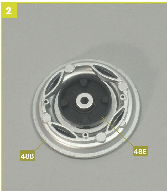
Das Foto zeigt die korrekt zusammengesetzte Bremstrommel und Außenfelge.
