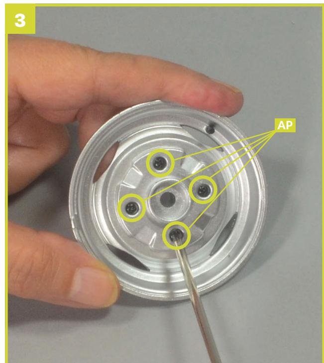
Drehen Sie die Außenfelge um und ziehen Sie vier Schrauben AP in den gezeigten Löchern fest, um die Bremstrommel zu fixieren.
