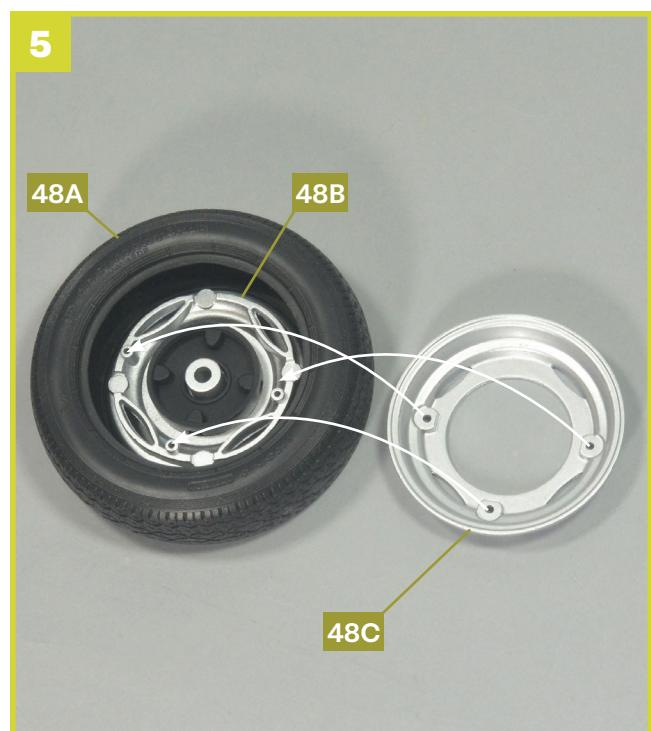
Positionieren Sie die Innenfelge 48C so auf der Außenfelge 48B, dass die drei Schraubenlöcher fluchten.
