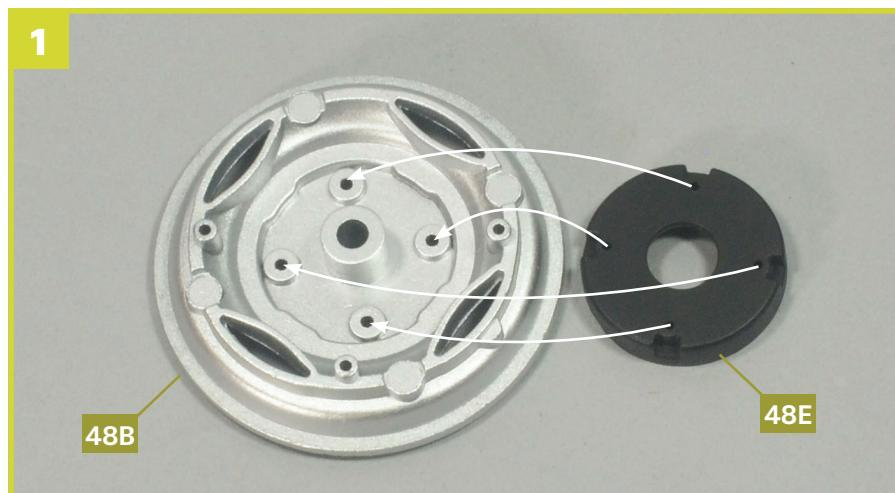
Setzen Sie die Bremstrommel **48E** so auf die Mitte der Außenfelge **48B**, dass die Montagevorrichtungen fluchten.
