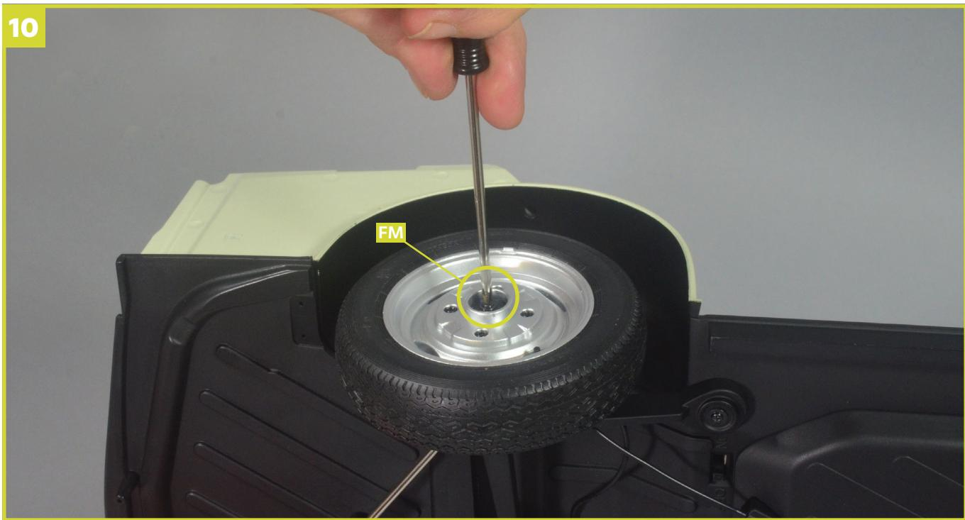
Befestigen Sie das nunmehr um den Abstandhalter vervollständigte Rad mit einer Schraube **FM** an der rechten hinteren Radaufhängung.
