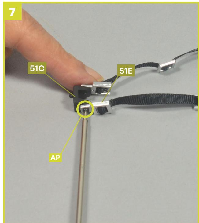
Verbinden Sie auch den rechten Sicherheitsgurt **51E** mit der Halterung **51C**, und fixieren Sie sie mit einer Schraube **AP**.
