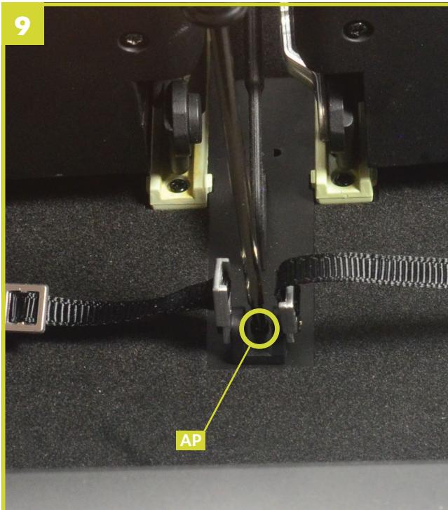
Fixieren Sie die Halterung mit einer Schraube **AP**.
