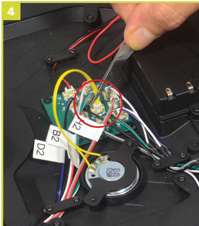
Verbinden Sie das Kabel des Lautsprechers **51A** mit dem Port **G**.
