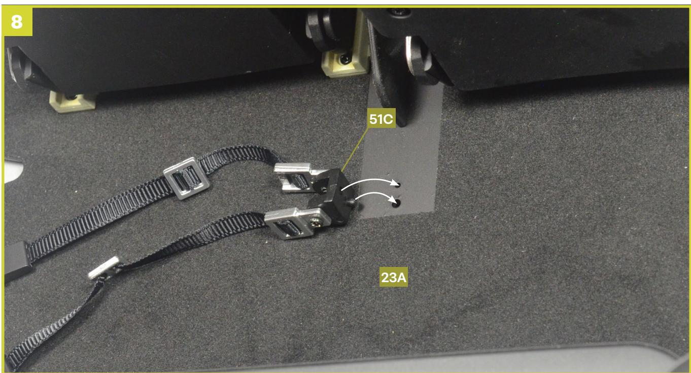
Fügen Sie die Halterung für die Sicherheitsgurte **51C** wie angedeutet in die Fußmulde des Bodenblechs **23A** ein.
