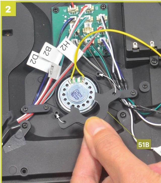
Positionieren Sie den Lautsprecherhalter **51B** so, dass seine Löcher mit den gebohrten Zapfen des Bodens fluchten.
