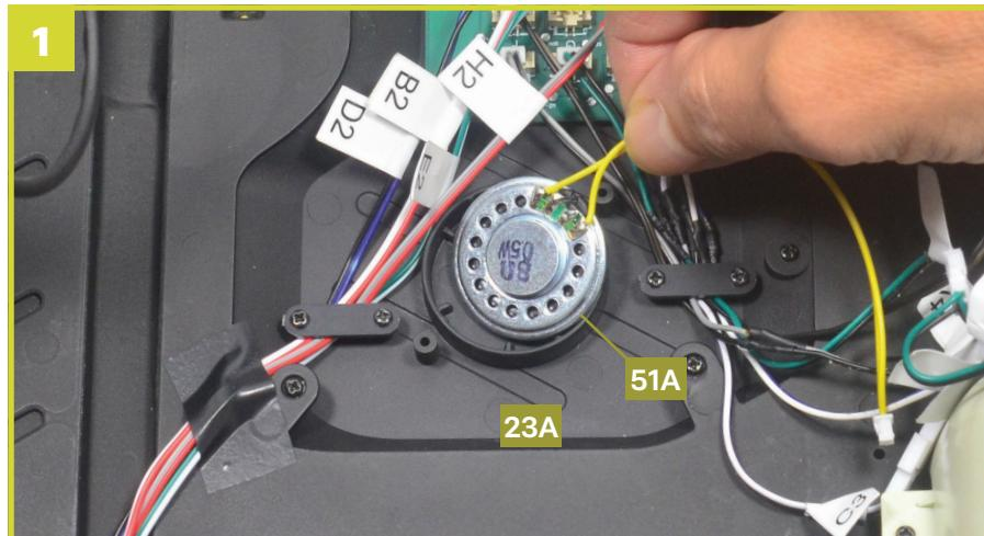
Setzen Sie den Lautsprecher **51A** in die runde Aussparung auf der Fußmulde des Bodenblechs **23A**, wie auf dem Foto gezeigt.
