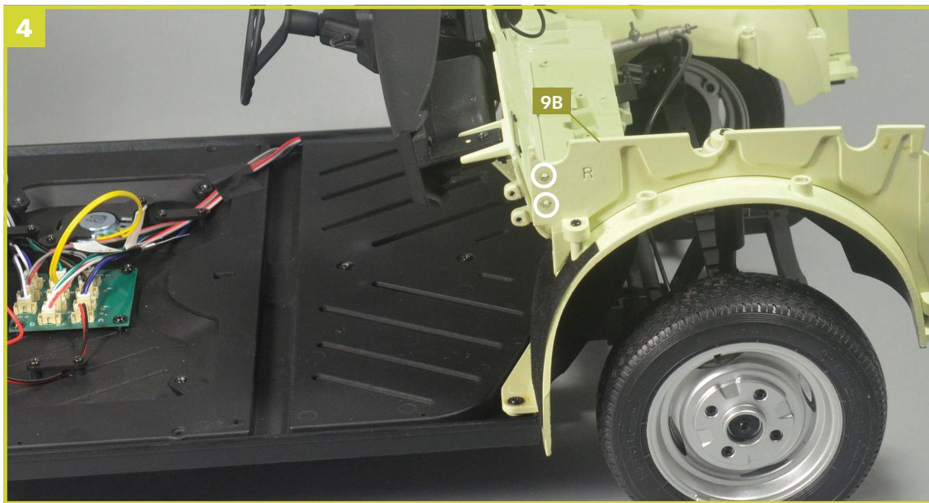
Entfernen Sie die beiden Schrauben **CM**, mit denen das rechte Motorraum-Seitenteil **9B** befestigt ist. Wiederholen Sie den Vorgang auf der anderen Seite, um das linke Motorraum-Seitenteil **8B** zu lösen. Bewegen Sie die beiden Motorraum-Seitenteile leicht nach außen. Bewahren Sie die vier entfernten Schrauben **CM** sorgfältig auf.
