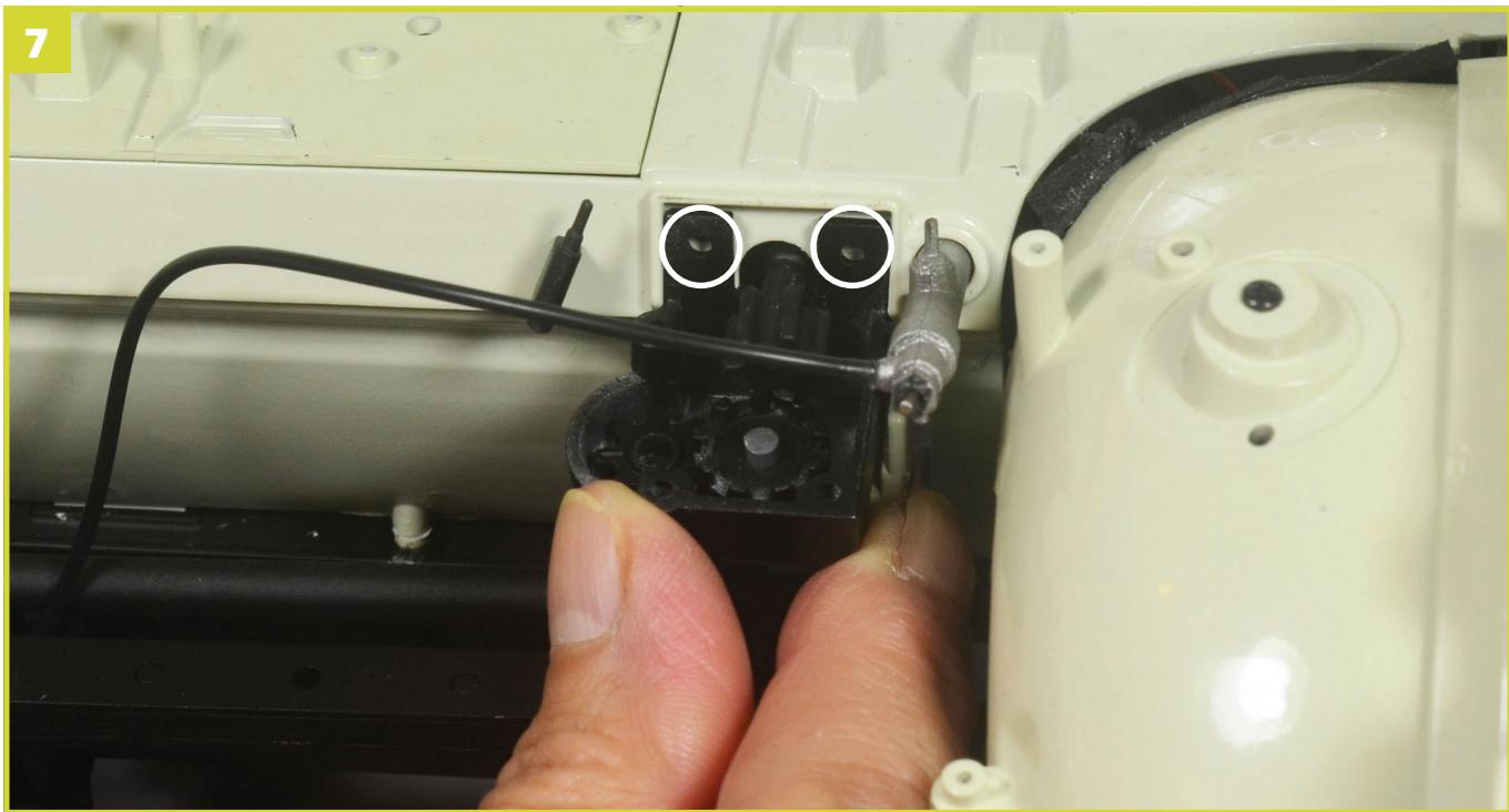
Richten Sie die Lenkgehäuse-Baugruppe so am Modell aus, dass die Schraubenlöcher fluchten.
