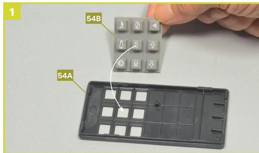
Setzen Sie das Tastenfeld 54B, ausgerichtet wie abgebildet, in das Vorderteil der Fernbedienung 54A ein.
