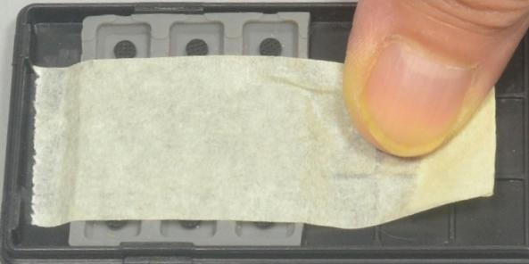
Prüfen Sie, dass jede Taste korrekt in der jeweiligen Aussparung des Vorderteils eingefügt ist.
