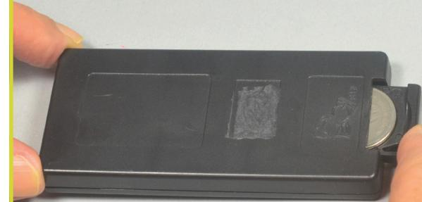
Das Batteriefach passt in die entsprechende Öffnung der Fernbedienung.
