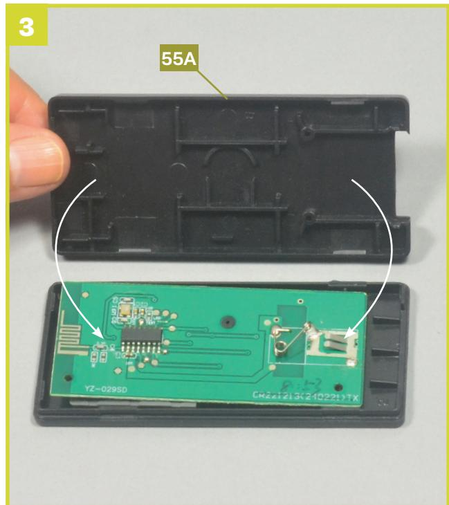
Setzen Sie die Platine **55C** wie gezeigt in das Vorderteil der Fernbedienung **54A** ein.
