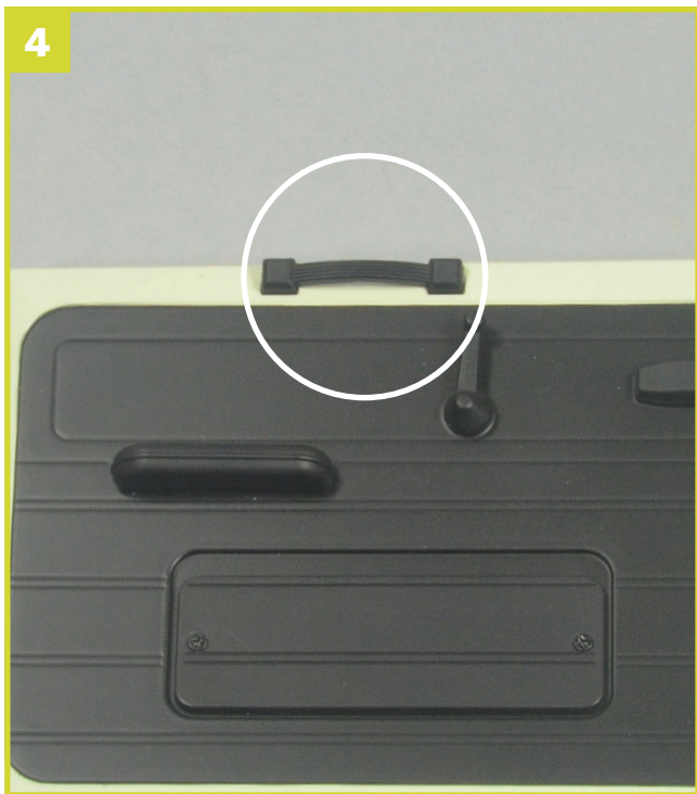
So sieht der korrekt montierte Türzuziehgriff 78B aus.
