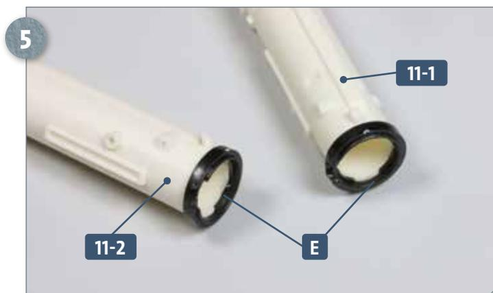
Das zweite Teil **E** wird innen ebenfalls mit etwas Sekundenkleber versehen und am Torpedorohr **11-2** fixiert.
