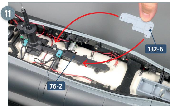
11 Nehmen Sie die Führungsschiene **132-6** und platzieren Sie sie so auf der Führung **76-2**, dass die Bohrungen beider Teile fluchten.
