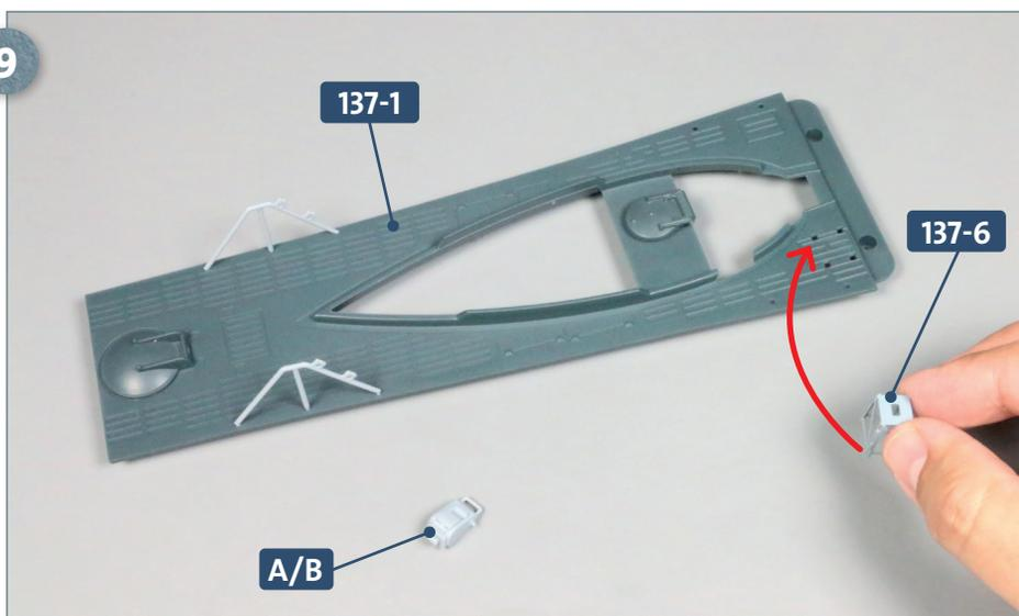
Versehen Sie die vier Füße des Gestells **137-6** mit etwas Sekundenkleber und fügen Sie sie in die vier rechteckigen Aufnahmen ganz vorne auf dem Decksabschnitt **137-1** ein, wie es der Pfeil exemplarisch andeutet. Legen Sie die Ladewinde **A/B** bereit.
