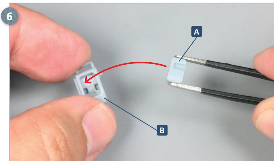
Trennen Sie die beiden Teile der Ladewinde **A** und **B** aus dem Rahmen **137-5**. Versehen Sie die beiden kleinen Zapfen von **A** mit etwas Sekundenkleber und fügen Sie sie in die Aufnahmen von **B** ein.
