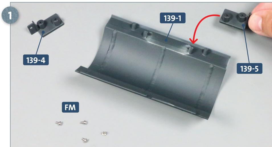
Platzieren Sie den Rumpfabschnitt **139-1** mit der Innenseite nach oben auf Ihrer Arbeitsplatte. Daneben legen Sie den Verbinder **139-4** und vier Schrauben **FM**. Nehmen Sie den Verbinder **139-5** und führen Sie ihn zu den vorderen Aufnahmen am Rumpfabschnitt, wie angedeutet.
