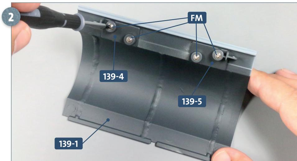
Fixieren Sie den Verbinder **139-5** mit zwei Schrauben **FM** am Rumpfabschnitt **139-1**. Anschließend setzen Sie den Verbinder **139-4** auf die hinteren Aufnahmen des Rumpfabschnitts und befestigen ihn ebenfalls mit zwei Schrauben **FM**.
