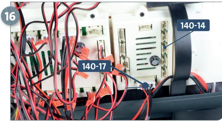
16 Nun werden die Kabel an der Platine **140-14** angeschlossen. Den Anfang macht das Verbindungskabel **140-17**, das in den unteren vierpoligen Port eingefügt wird.
