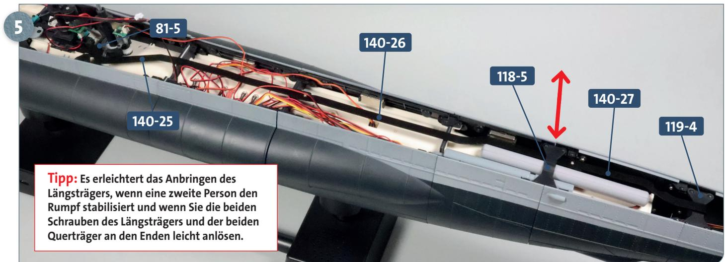
**Tipp:** Es erleichtert das Anbringen des Längsträgers, wenn eine zweite Person den Rumpf stabilisiert und wenn Sie die beiden Schrauben des Längsträgers und der beiden Querträger an den Enden leicht anlösen.
