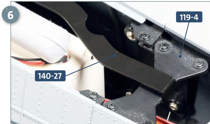
Das abgewinkelte hintere Ende des Längsträgers 140-27 umfasst den Querträger 119-4, wie abgebildet.
