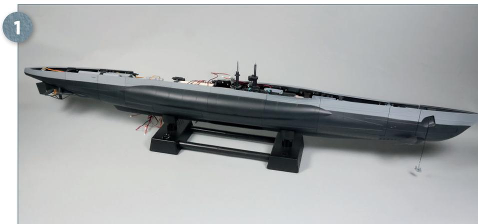
Positionieren Sie Ihr Modell auf dem mit einer neuen Platine ausgestatteten Ständer, wie abgebildet. Mit den nächsten Bauschritten werden die Kabel mit den beiden neuen Rumpflatinen verbunden.
