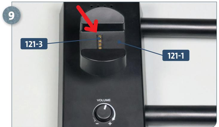
Wie schon in der Bauanleitung der Ausgabe 121 beschrieben: Achten Sie unbedingt darauf, dass sich die Öffnung für die Kontakte **121-3** (Pfeil) nicht mittig, sondern etwas nach links versetzt in der Halterung **121-1** befindet.
