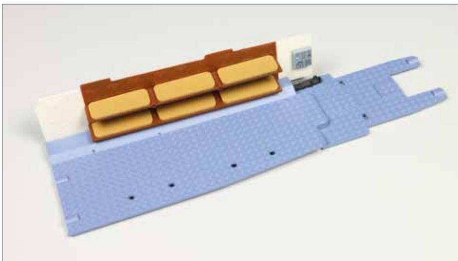
**Der Zusammenbau des Bugraums schreitet voran: Die Kojen sind an der Rückwand befestigt, diese ist mit der Bodenplatte verbunden.**
