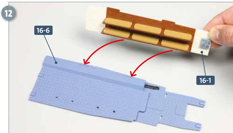
Versehen Sie die Unterkante und die beiden breiten Zapfen der Rückwand 16-1 mit Sekundenkleber und fügen Sie das Teil in die entsprechenden Schlitz im Boden 16-6 ein, wie es die beiden Pfeile andeuten.
