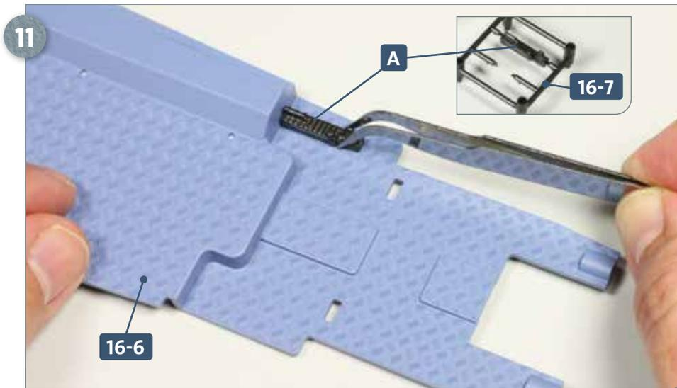
Legen Sie den Boden des Bugraums 16-6 bereit. Trennen Sie das Teil A aus dem Rahmen 16-7 und versehen Sie seine beiden Zapfen mit etwas Sekundenkleber. Kleben Sie das Teil A in den beiden Bohrungen am vorderen Ende vom Boden des Bugraums 16-6 fest, wie es das Foto zeigt.
