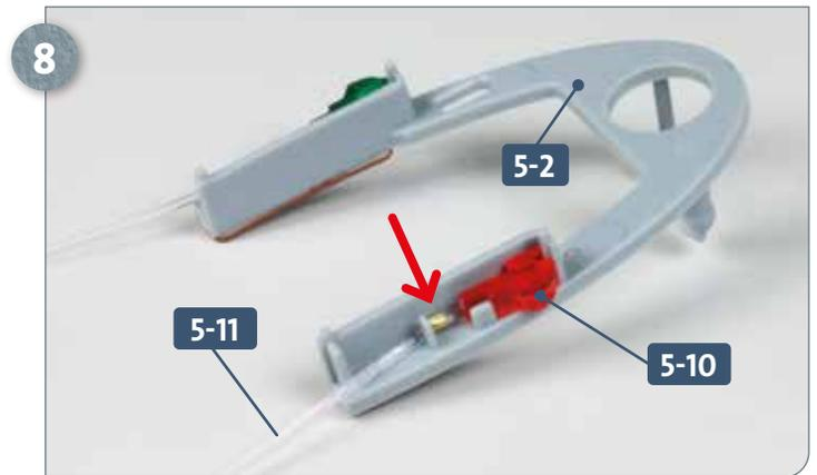
Gleiches Spiel mit dem zweiten Lichtleitkabel **5-11**: Es endet hinter der Backbord-Positionslaterne **5-10**, seine Schelle (Pfeil) befindet sich vor dem Zapfen der Trittstufe **5-2**.
