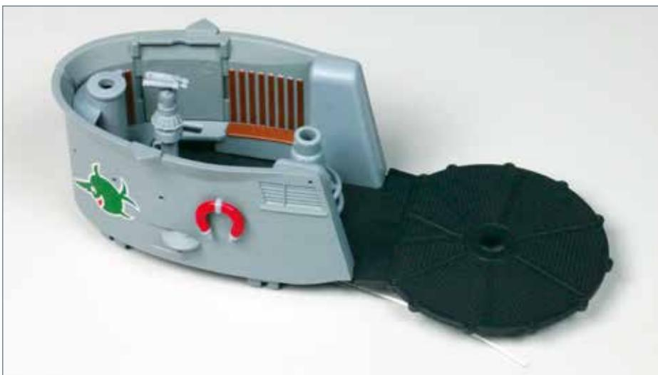
Die Positionslaternen und Lichtleitkabel sind an der Trittstufe angebracht. Die Trittstufen-Baugruppe und die beiden Schanzkleid-Hälften sind mit dem Brückendeck verbunden: Der Turm des Modells hat seine endgültige Gestalt angenommen.
