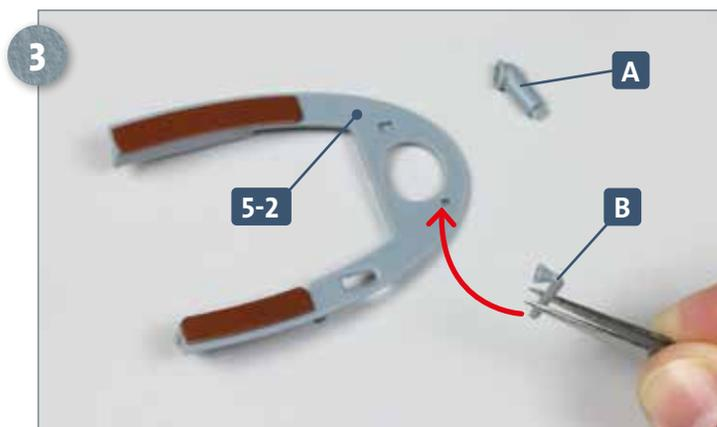
Trennen Sie die beiden Teile aus dem Rahmen 5-5. Nehmen Sie das Sprachrohr B, geben Sie Klebstoff auf dessen Unterseite und fixieren Sie es in der Vertiefung der Trittstufe 5-2, auf die der Pfeil weist.
