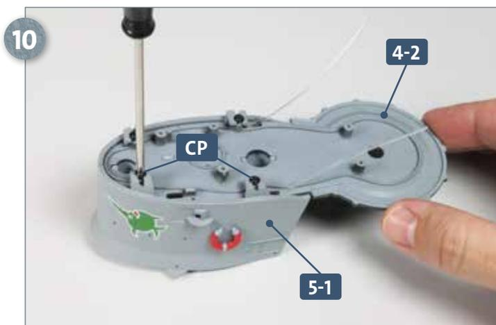
Befestigen Sie die rechte Schanzkleid-Hälfte 5-1 mit den beiden Schrauben CP am Brückendeck 4-2, wie abgebildet.
