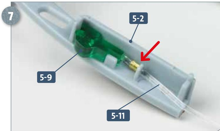
Platzieren Sie das vordere Ende vom ersten Lichtleitkabel **5-11** so hinter der Steuerbord-Positionslaterne **5-9**, dass sich die Schelle des Kabels (Pfeil) vor dem Zapfen der Trittstufe **5-2** befindet, wie es das Foto zeigt.
