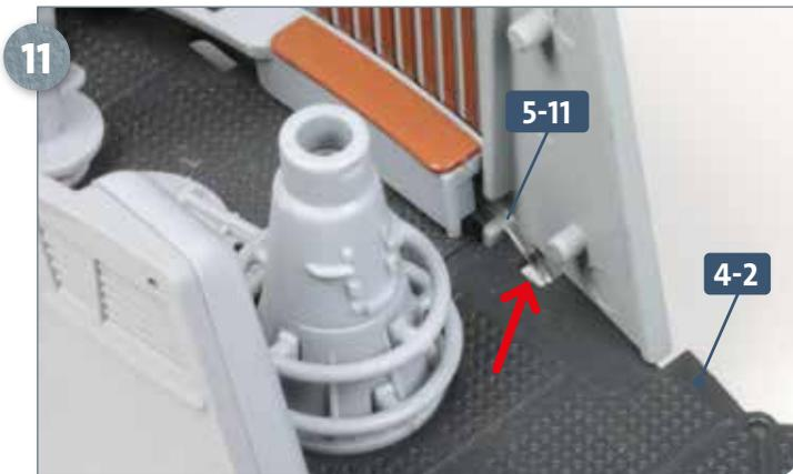
11 Auch auf dieser Seite des Turms achten Sie bitte darauf, dass das Lichtleitkabel 5-11 durch die Aussparung im Brückendeck 4-2, auf die der Pfeil weist, nach unten geführt wird.
