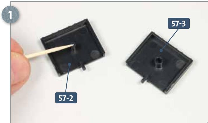
Legen Sie je eine Batteriezellenhälfte **57-2** und **57-3** auf Ihre Arbeitsplatte, mit den Innenseiten nach oben. Versehen Sie den Zapfen von Teil **57-2** mit etwas Sekundenkleber, wie abgebildet.
