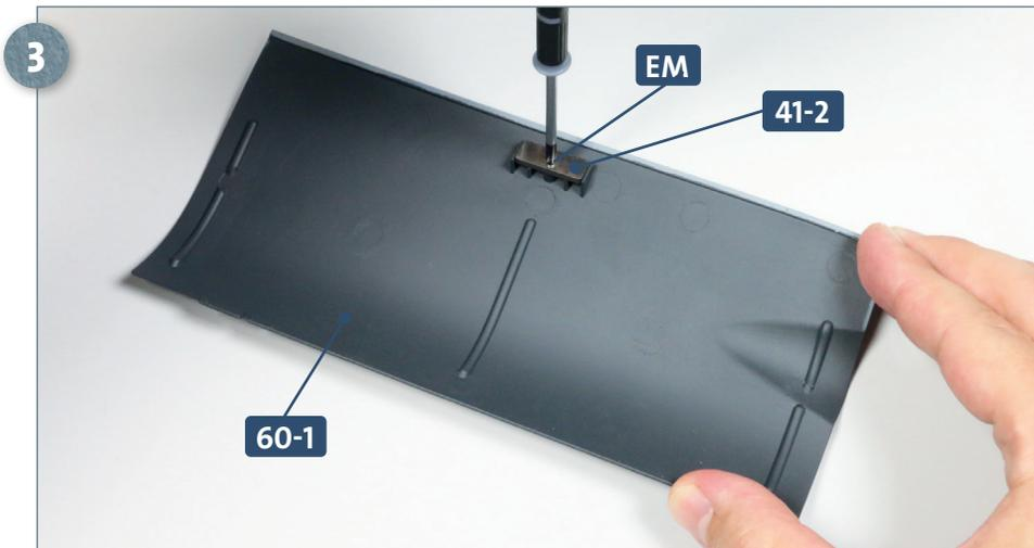
Nun legen Sie den neuen Rumpfabschnitt **60-1** mit der Außenseite nach unten auf Ihre Arbeitsplatte. Setzen Sie die Metallplatte **41-2** auf und befestigen Sie sie mit der Schraube **EM**, wie abgebildet.
