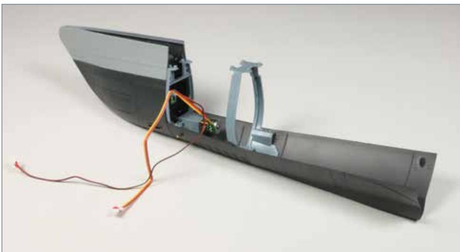
Die Rumpfstruktur ist um ein Verbindungsstück und einen weiteren unteren Rumpfabschnitt gewachsen.
