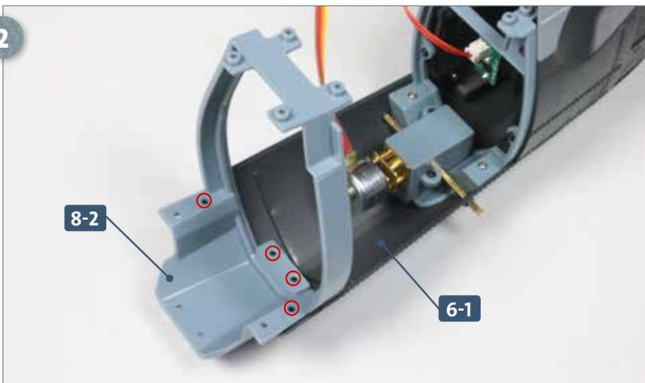
Das Verbindungsstück 8-2 ist korrekt auf dem Rumpfabschnitt 6-1 platziert, wenn vier der Bohrungen beider Teile fluchten (eingekreist).
