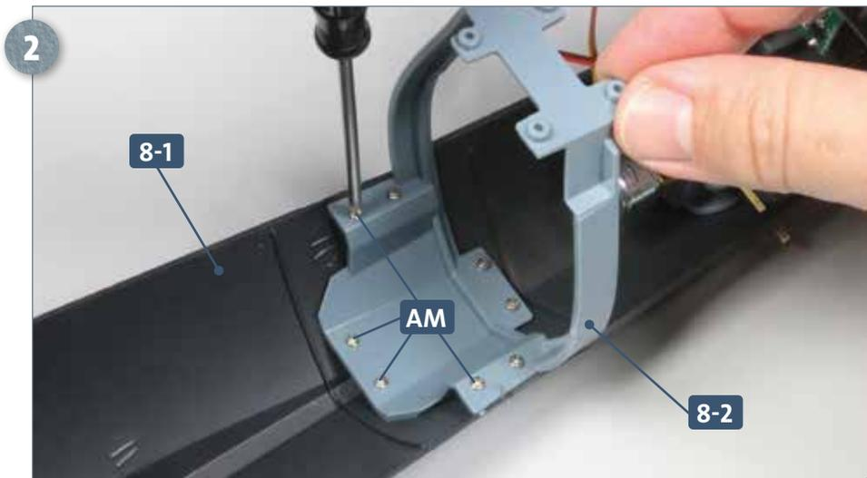
Fixieren Sie den unteren Rumpfabschnitt **8-1** am Verbindungsstück **8-2**, indem Sie vier Schrauben **AM** in die auf dem Bild gezeigten Löcher eindrehen.
