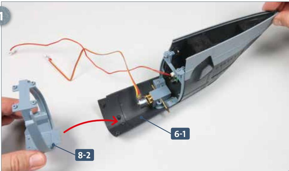
Nehmen Sie die große Rumpfbaugruppe zur Hand, die Sie zuletzt in Ausgabe 6 bearbeitet haben. Führen Sie das Verbindungsstück 8-2 so zum hinteren Ende des unteren Rumpfabschnitts 6-1, wie es der Pfeil andeutet.
