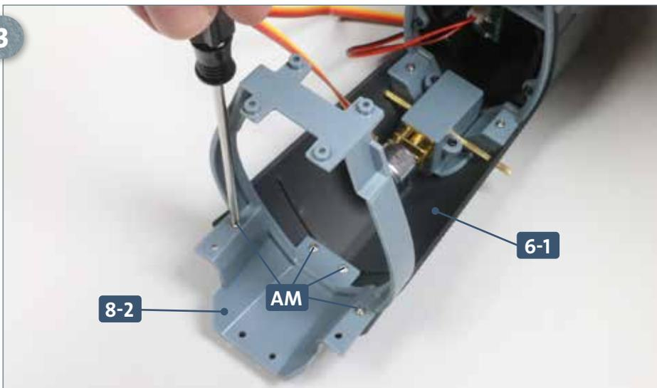
Befestigen Sie das Verbindungsstück 8-2 mit vier Schrauben AM am Rumpfabschnitt 6-1.
