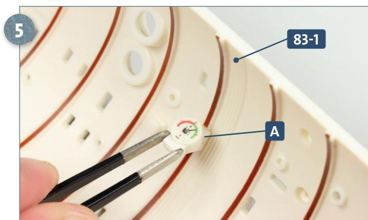
Geben Sie etwas Sekundenkleber auf das Ende des Teils **A** und fügen Sie es in die Öffnung der Decke des E-Maschinenraums **83-1** ein.
