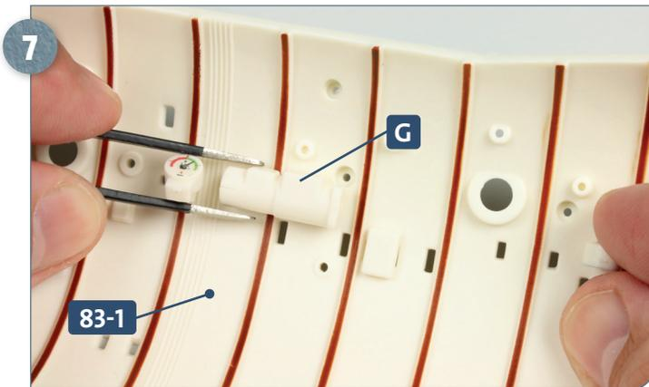
7 Nehmen Sie den längeren der beiden zusammengeführten Umformer, versehen Sie den Zapfen von Teil **G** mit etwas Sekundenkleber und fügen Sie diesen in die Aufnahme der Decke **83-1** ein.
