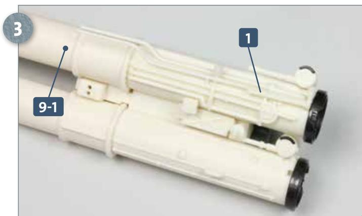
Der Zapfen am Ende der Leitung **1** wird mit etwas Klebstoff versehen und in der Vertiefung des Torpedorohrs **9-1** fixiert.
