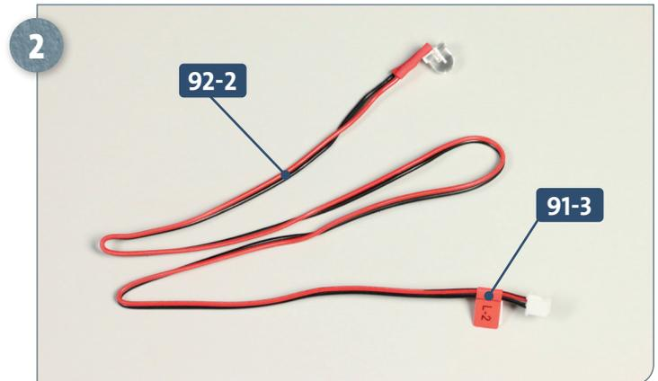
Lösen Sie die Kabelmarkierung **91-3** mit dem Aufdruck „L-2“ von der Trägerfolie und kleben Sie sie am Kabel **92-2** fest, etwa 8 mm von dessen Stecker-Ende entfernt.
