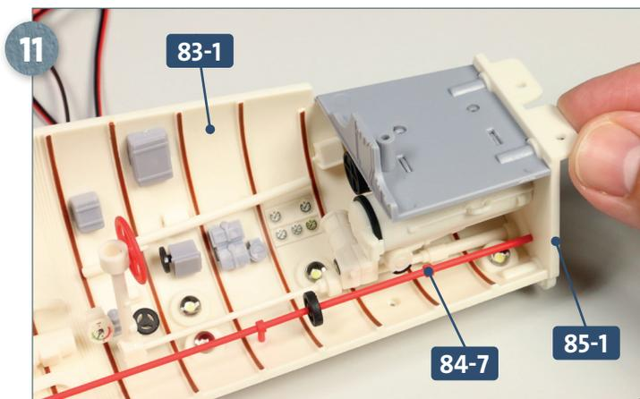
11 Fügen Sie die Decke **83-1** und den Endboden **85-1** zusammen. Achten Sie dabei darauf, dass das hintere Ende des Bedienungsgestänges **84-7** in die Bohrung des Endbodens eingefügt wird.
