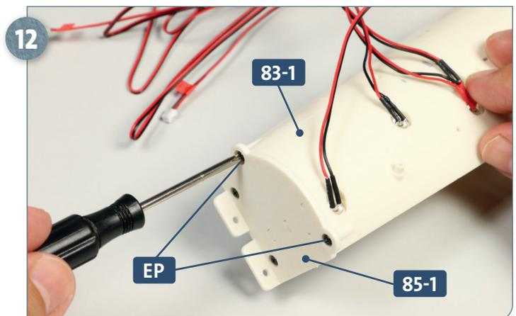
12 Befestigen Sie den Endboden **85-1** mit zwei Schrauben **EP** an der Decke **83-1**, wie es das Foto zeigt.
