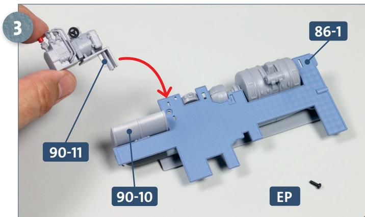
Kleben Sie die Torpedozelle **90-10** am seitlichen Zapfen der Flurplatte **86-1** fest. Legen Sie eine weitere Schraube **EP** bereit. Nehmen Sie den E-Luftverdichter und platzieren Sie die beiden Zapfen des Fundaments **90-11** in den Schlitzen der Flurplatte.
