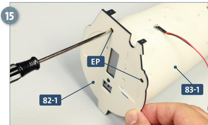
15 Befestigen Sie das vordere E-Maschinenraumschott **82-1** mit zwei Schrauben **EP** an der Decke **83-1**.
