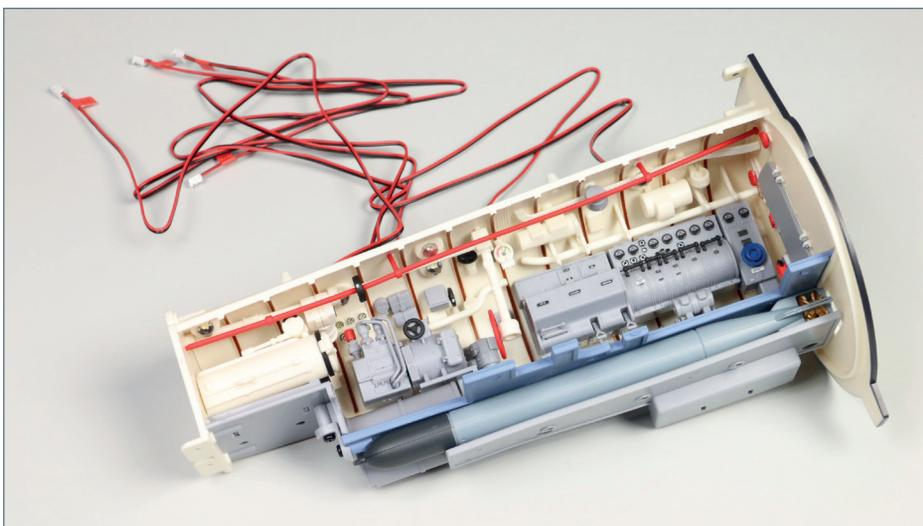
Die sechste Sektion ist zusammengefügt. LEDs sind in ihre Decke eingesetzt.
