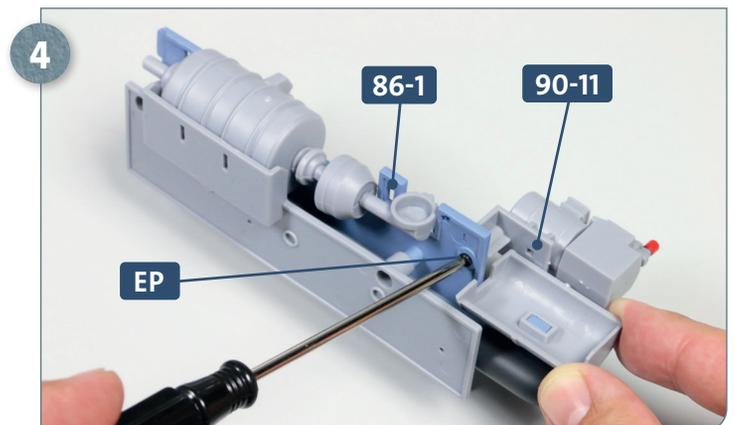
Befestigen Sie das Fundament des E-Luftverdichters **90-11** mit der Schraube **EP** an der Flurplatte **86-1**, wie es das Foto zeigt.
