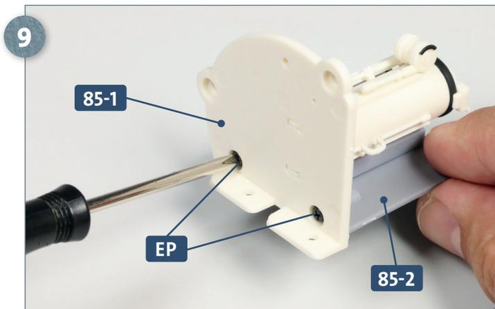
9 Befestigen Sie den Endboden **85-1** an der Trimmzelle **85-2**, indem Sie zwei Schrauben **EP** in die abgebildeten Bohrungen eindrehen.
