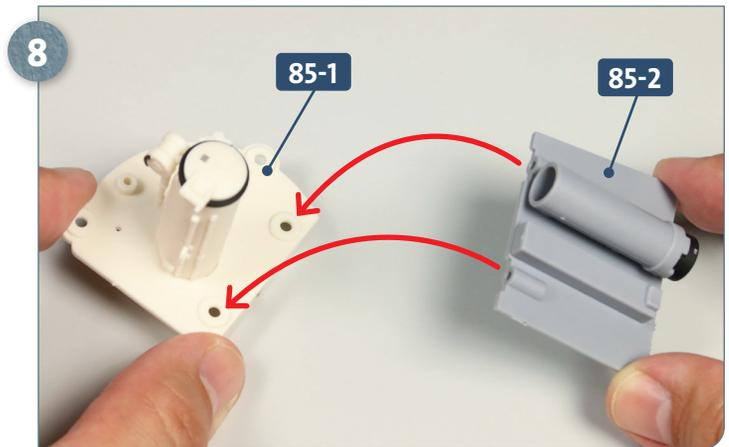
8 Die Endmontage der sechsten Sektion beginnt mit dem Endboden **85-1** und der Trimmzelle **85-2**. Fügen Sie beide Teile so zusammen, wie es die beiden Pfeile andeuten.
