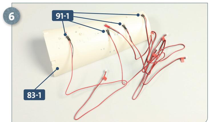
Die vier weißen LEDs **91-1** gehören in die vier anderen Bohrungen der Decke **83-1**, wie es das Foto zeigt.
