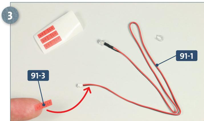
Legen Sie eins der Kabel **91-1** mit weißer LED (und schwarzer Manschette) bereit. Lösen Sie eine der Kabelmarkierungen **91-3** mit dem Aufdruck „L-1“ von der Trägerfolie und kleben Sie sie am Stecker-Ende des Kabels fest, wie angedeutet.
