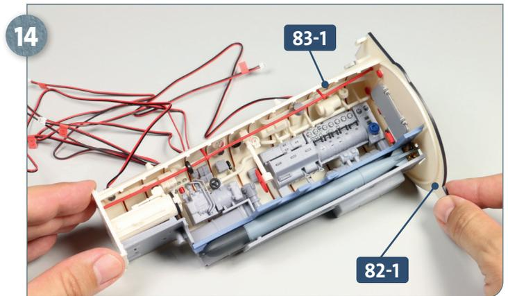
14 Platzieren Sie das vordere E-Maschinenraumschott **82-1** so am vorderen Ende der Decke **83-1**, dass die zwei Bohrungen der beiden Teile fluchten.
