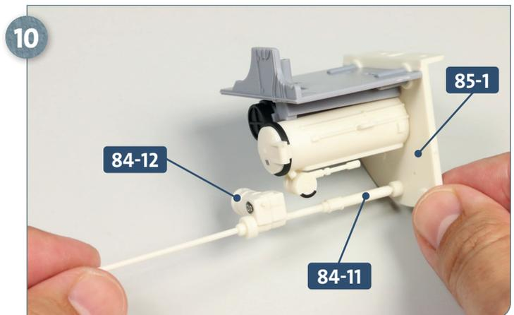
10 Nehmen Sie die in Ausgabe 84 zusammengebaute Baugruppe mit dem Haupt-Rudermotor **84-12** zur Hand. Versehen Sie das Ende der Antriebswelle **84-11** mit etwas Sekundenkleber und fügen Sie es in die Aufnahme des Endbodens **85-1** ein.
