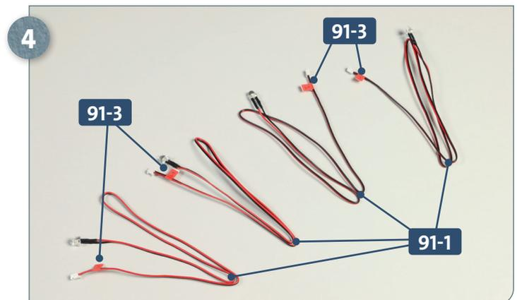
Versehen Sie auch die übrigen drei Kabel mit weißer LED **91-1** jeweils mit einer Kabelmarkierung **91-3**. Prüfen Sie die Funktionalität aller fünf LED-Kabel, indem Sie sie mit der Testplatine **3-8** verbinden (siehe hierzu u. a. Bauanleitung 43).
