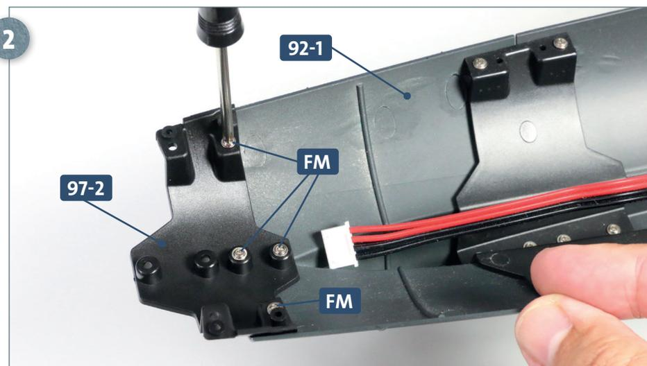
Das am Rumpfabschnitt **92-1** aufgesetzte Verbindungsstück **97-2** wird mit vier Schrauben **FM** befestigt.
