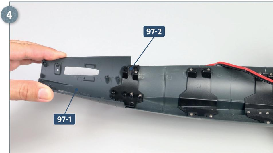
Platzieren Sie den Rumpfabschnitt **97-1** so unter dem Verbindungsstück **97-2**, dass die Aufnahmen bzw. Bohrungen der beiden Teile fluchten.
