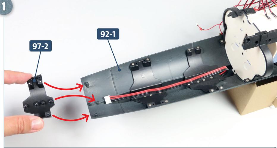
Stellen Sie die Rumpfstruktur auf Ihre Arbeitsplatte. Nehmen Sie das Verbindungsstück **97-2**, richten Sie es aus, wie abgebildet, und führen Sie dessen vordere Bohrungen zu den Aufnahmen am unteren Rumpfabschnitt **92-1**, wie es die Pfeile andeuten.
