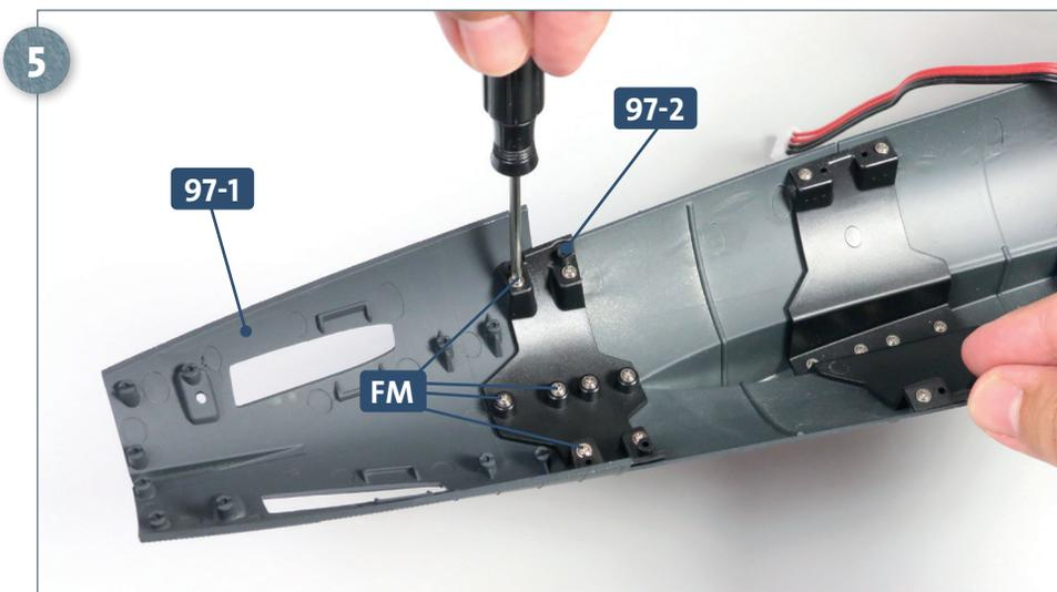
Fixieren Sie den Rumpfabschnitt **97-1** mit den vier Schrauben **FM** am Verbindungsstück **97-2**, wie abgebildet.
