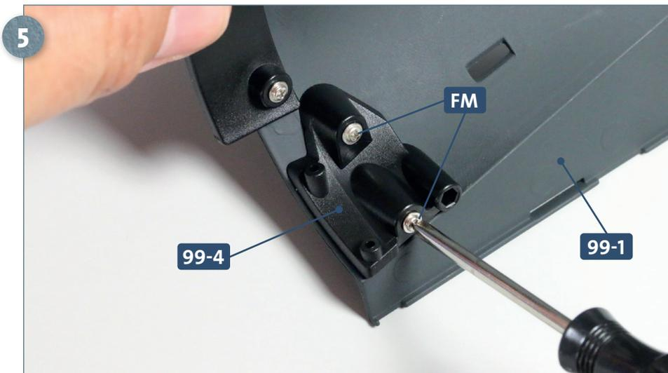
Nehmen Sie den Verbinder **99-4**, setzen Sie ihn auf die verbliebenen Aufnahmen des Rumpfabschnitts **99-1** und befestigen Sie ihn mit zwei Schrauben **FM** an diesem.
