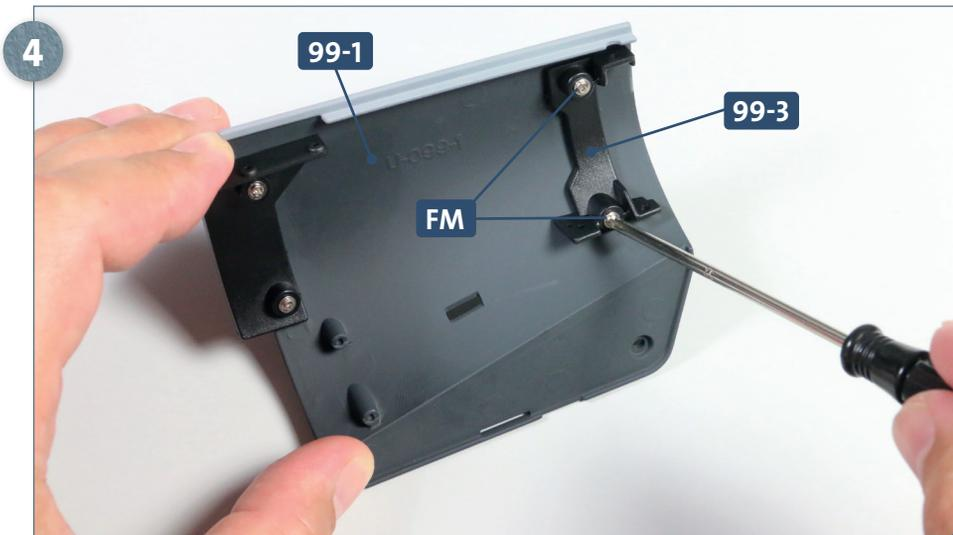
Fixieren Sie den Verbinder **99-3** mit den zwei Schrauben **FM** am Rumpfabschnitt **99-1**, wie abgebildet.
