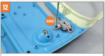
Befestigen Sie das Gehäuse mit zwei Schrauben **DS02** an der Karosserie.
