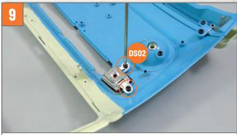
Befestigen Sie das Gehäuse mit zwei Schrauben **DS02** an der Karosserie.
