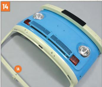
Setzen Sie den Kühlergrill **2C** so in die Aussparung der Karosserie **1A** ein, dass dessen Laschen über den Schlitzen in der Karosserie positioniert sind.
