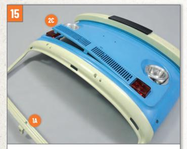
Lassen Sie die Laschen des Kühlergrills **2C** schrittweise in die Schlitze in der Karosserie **1A** einrasten, wie in der Abbildung gezeigt.
