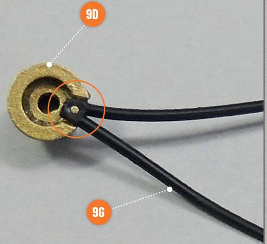
Stecken Sie die Öse des Benzinschlauchs **9G** auf den Stift der Innenseite der Kappe **9D** und richten Sie die Teile genau wie auf dem Foto gezeigt aus.
