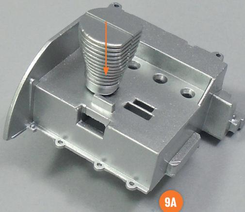
Installieren Sie einen der beiden Zylinder in die auf dem Foto gezeigte Vertiefung im rechten Motorteil **9A**, indem Sie den Zylinderfuß in die entsprechende Aussparung einführen.
