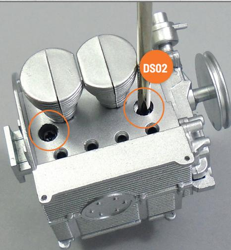
Befestigen Sie die beiden Hälften des Motorblocks mit zwei Schrauben **DS02**.
