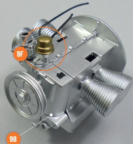
Stecken Sie den Stift der Benzinpumpe **9F** in das entsprechende Loch der Frontplatte **9B**, wie der Kreis auf dem Foto zeigt.
