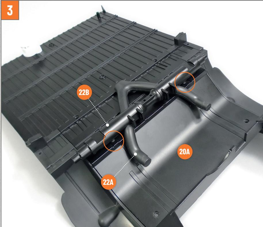
Jetzt arbeiten Sie wieder an der Unterseite des Bodenblechs. Installieren Sie die Hinterachse **22B** auf den Heizrohrverteiler **22A** und richten Sie die Teile wie gezeigt aus. Stecken Sie die Stifte der Hinterachse in die entsprechenden Löcher am hinteren Teil des Bodenblechs, wie auf dem Foto durch Kreise angezeigt.
