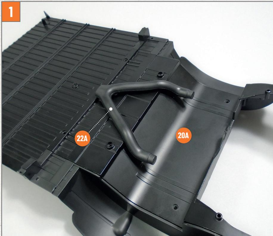
Nehmen Sie das Bodenblech Ihres im Bau befindlichen Modells zur Hand. Installieren Sie den Heizrohrverteiler **22A** an der gezeigten Stelle an der Unterseite der Rückseite des Bodenblechs **20A**. Richten Sie die Teile wie auf dem Foto gezeigt aus und stecken Sie die drei Stifte des Rohrs in die entsprechenden Löcher im Bodenblech.
