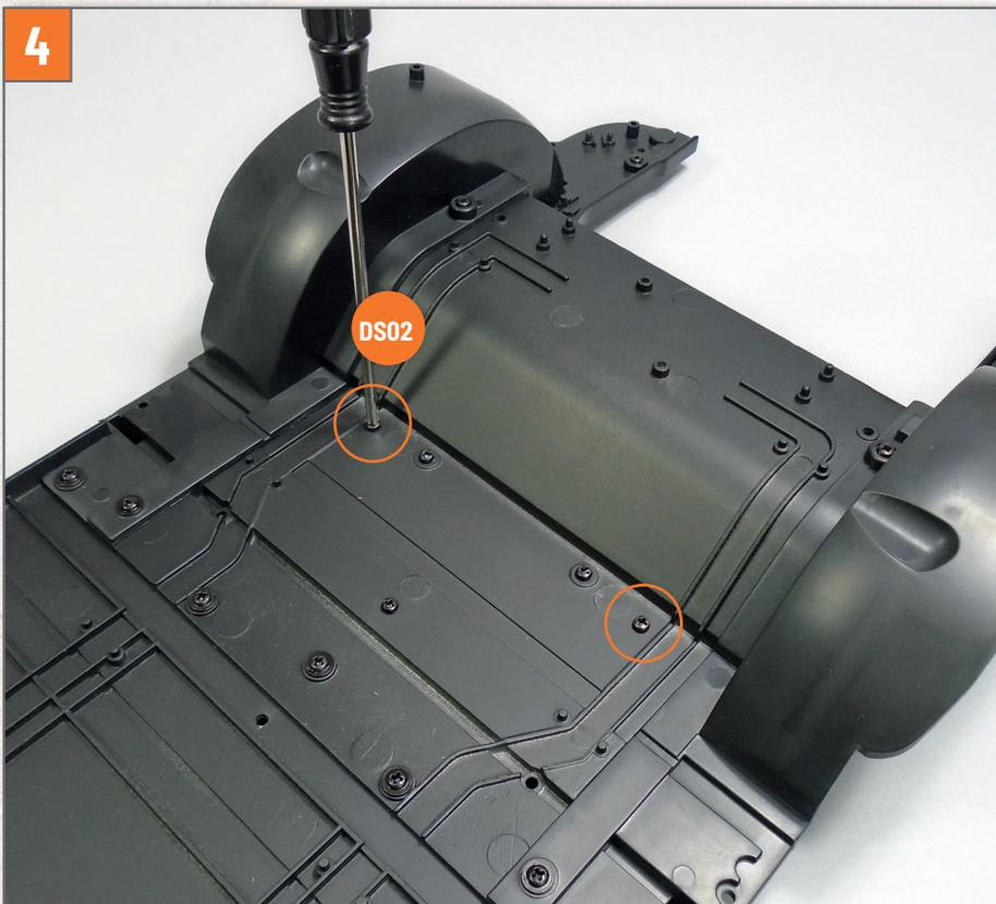
Drehen Sie die Baugruppe um und befestigen Sie die Teile aneinander, indem Sie zwei Schrauben **DS02** in den auf dem Foto durch Kreise markierten Löchern auf der Oberseite des Bodenblechs festziehen.
