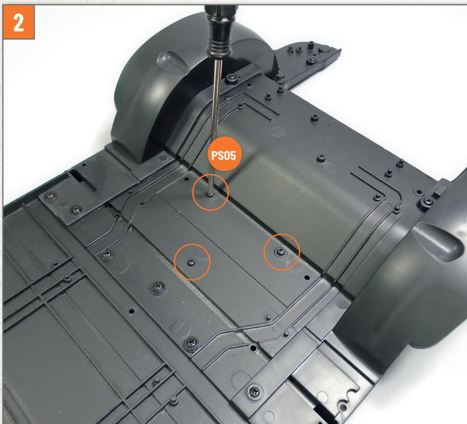
Arbeiten Sie auf der Oberseite des Bodenblechs und befestigen Sie das Rohr in dieser Position, indem Sie drei Schrauben **PS05** in den auf dem Foto durch die Kreise markierten Löchern festziehen.
