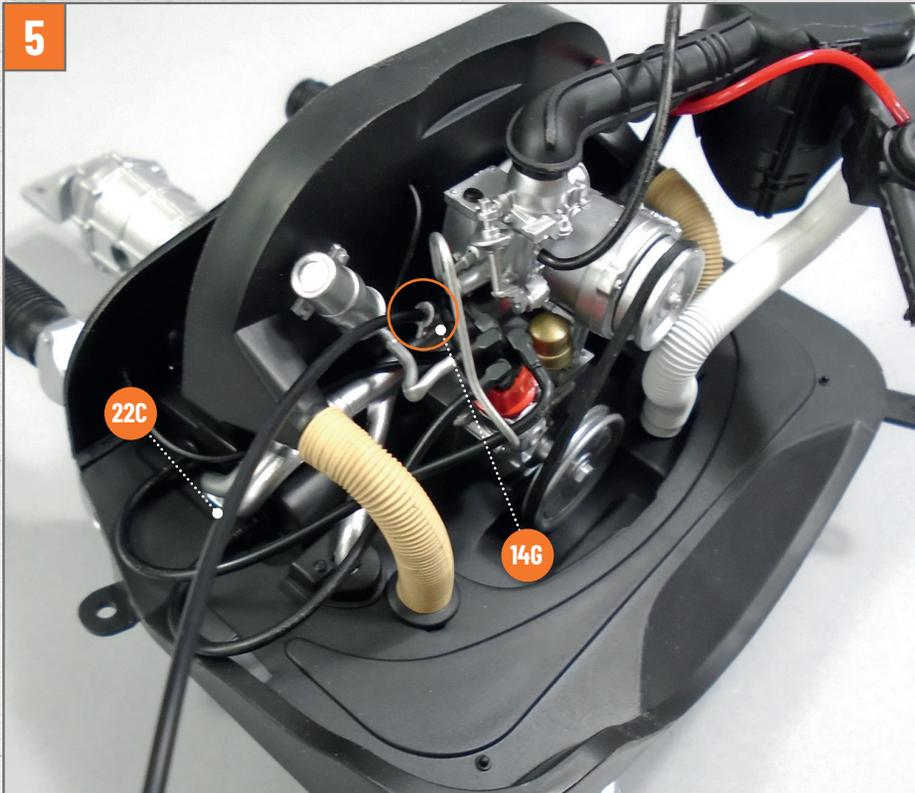
Stecken Sie ein Ende des Benzinschlauchs **22C** auf den freien Stift des Verbindungsstücks des Saugrohrs **14G**.
