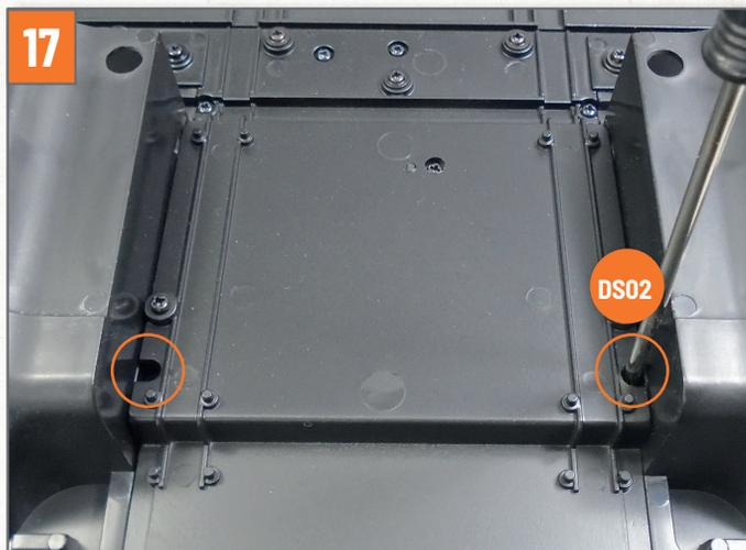
Schließen Sie nun die Befestigung der Vorderachse mit der restlichen Gruppe ab, indem Sie zwei Schrauben **DS02** in den auf dem Foto durch Kreise markierten Löchern an der Oberseite der Bodengruppe festziehen.
