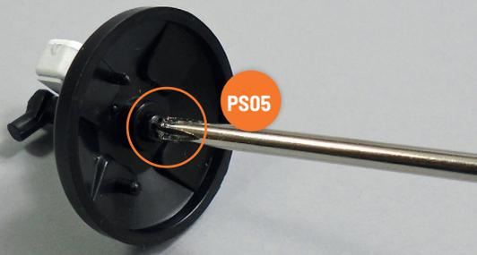
Halten Sie den Hauptbremszylinder in dieser Position und befestigen Sie ihn am Deckel, indem Sie eine Schraube **PS05** in dem auf dem Foto markierten Loch festziehen.
