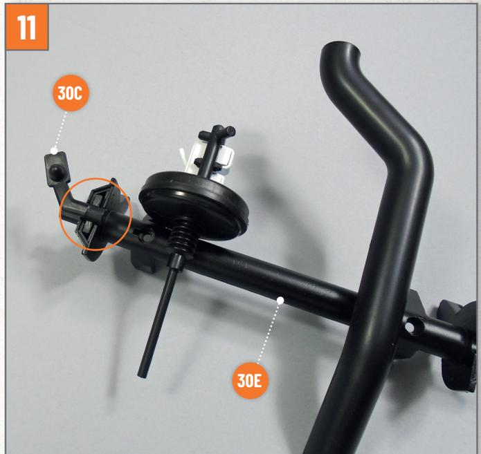
11 Installieren Sie die linke Gummimanschette **30C** (gekennzeichnet mit dem Buchstaben „L“) am linken Ende des Oberteils der Vorderachse **30E**.
