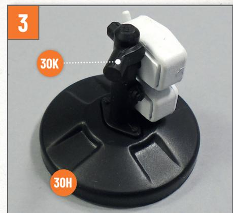
Stecken Sie das mit zwei Stiften ausgestattete Ende des Hauptbremszylinders **30K** in die Mitte des Deckels des Bremskraftverstärkers **30H**. Die Stifte des Hauptbremszylinders haben unterschiedliche Durchmesser, daher ist nur eine Montagerichtung möglich.
