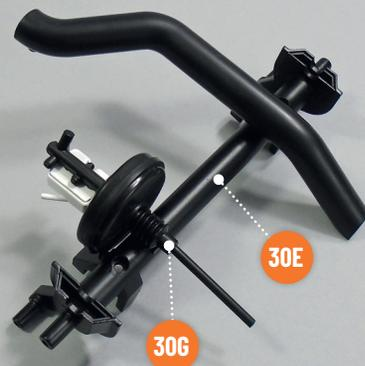
Stecken Sie den Stift des Bremskraftverstärkers **30G** in das entsprechende Loch im Oberteil der Vorderachse **30E** und richten Sie die Teile wie auf dem Foto gezeigt aus.
