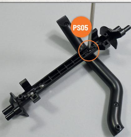
Arbeiten Sie jetzt an der Innenseite der Baugruppe und befestigen Sie das Heizrohr am Oberteil der Vorderachse, indem Sie eine Schraube **PS05** in dem auf dem Foto durch einen Kreis markierten Loch festziehen.
