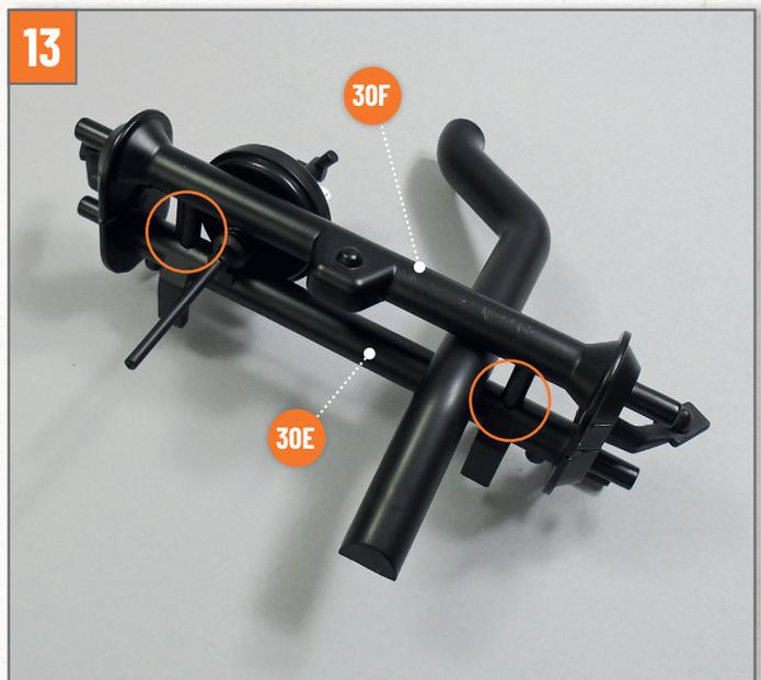
13 Setzen Sie das Unterteil der Vorderachse **30F** auf das Oberteil **30E**. Anhand des Fotos und der Form der Teile können Sie sie korrekt ausrichten.
