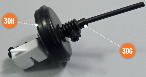
Setzen Sie den Bremskraftverstärker **30G** auf seinen Deckel **30H** und richten Sie die Teile wie auf dem Foto gezeigt aus.
