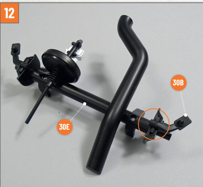
12 Installieren Sie ebenso die rechte Gummimanschette **30B** (gekennzeichnet mit dem Buchstaben „R“) am rechten Ende des Oberteils der Vorderachse **30E**.
