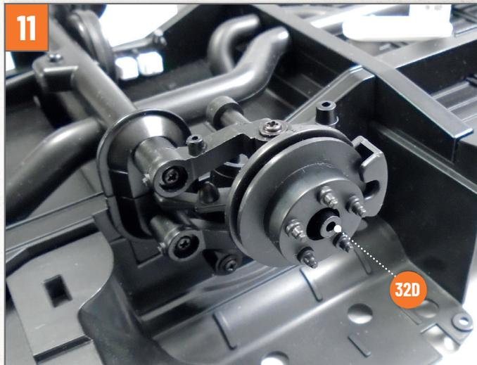
Platzieren Sie die Bremsscheibenbaugruppe auf dem Stift des rechten vorderen Achsschenkels **32D** und richten Sie die Teile dabei wie auf dem Foto gezeigt aus.
