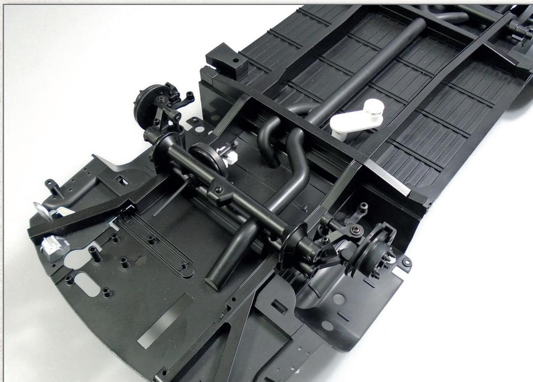
So sieht die Unterseite der Bodengruppe Ihres Modells nach dem Einbau der neuen Komponenten von Bremse, Lenkung und Vorderradaufhängung aus.
