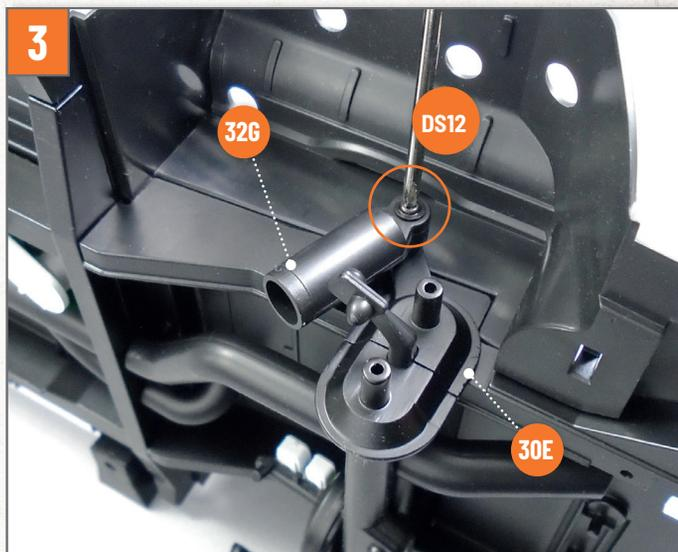
Nehmen Sie die Bodengruppe Ihres Modells wieder zur Hand. Stecken Sie das Loch am oberen Teil des Stoßdämpfers **32G** auf den entsprechenden Stift am rechten Ende des Oberteils der Vorderachse **30E**. Richten Sie die Teile wie auf dem Foto gezeigt aus und befestigen Sie sie mit einer Schraube **DS12**.
