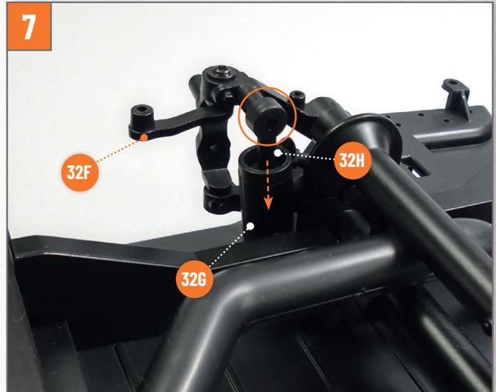
Stecken Sie den Schaft des Stoßdämpfers **32H** in seinen Oberteil **32G** und drücken Sie dabei fest auf die Feder. Stecken Sie die Öse des Stoßdämpfers auf den Stift des unteren Traghebels **32F**, wie auf dem Foto durch den Kreis gezeigt.
