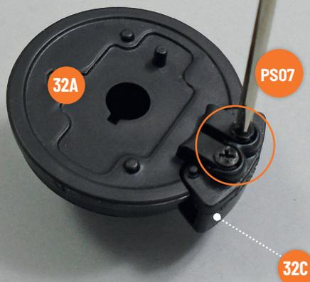
Installieren Sie den Bremssattel **32C** in der auf dem Foto gezeigten Position und richten Sie seine Löcher mit denen der Laschen des Bremsträgers **32A** aus. Befestigen Sie die Teile mit zwei Schrauben **PS07**.
