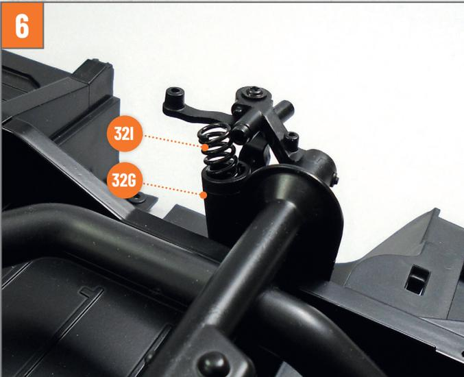
Setzen Sie die Feder **32I** oben in den Stoßdämpfer **32G**.
