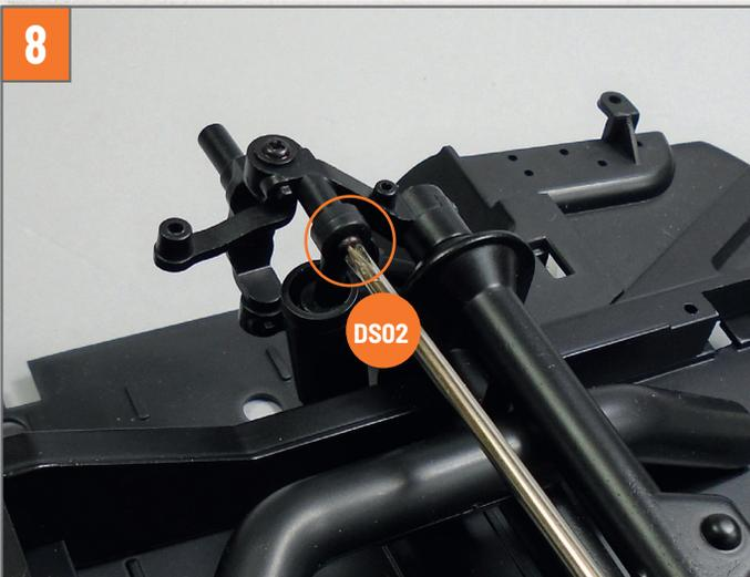
Befestigen Sie den Stoßdämpfer mit einer Schraube **DS02** am Traghebel.
