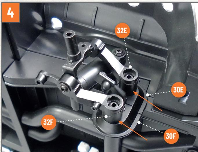
Stecken Sie die größeren Ösen des oberen (**32E**) und unteren (**32F**) Traghebels auf die jeweiligen Bohrstifte am rechten Ende der Vorderachse (Oberteil **30E** und Unterteil **30F**). Richten Sie die Teile dabei so wie auf dem Foto aus.
