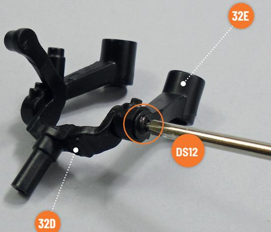
Stecken Sie die kleinere Öse des oberen Traghebels **32E** auf den Stift am gegenüberliegenden Ende des Achsschenkels **32D** und richten Sie die Teile dabei wie auf dem Foto gezeigt aus. Befestigen Sie den oberen Traghebel mit einer Schraube **DS12** am Achsschenkel.
