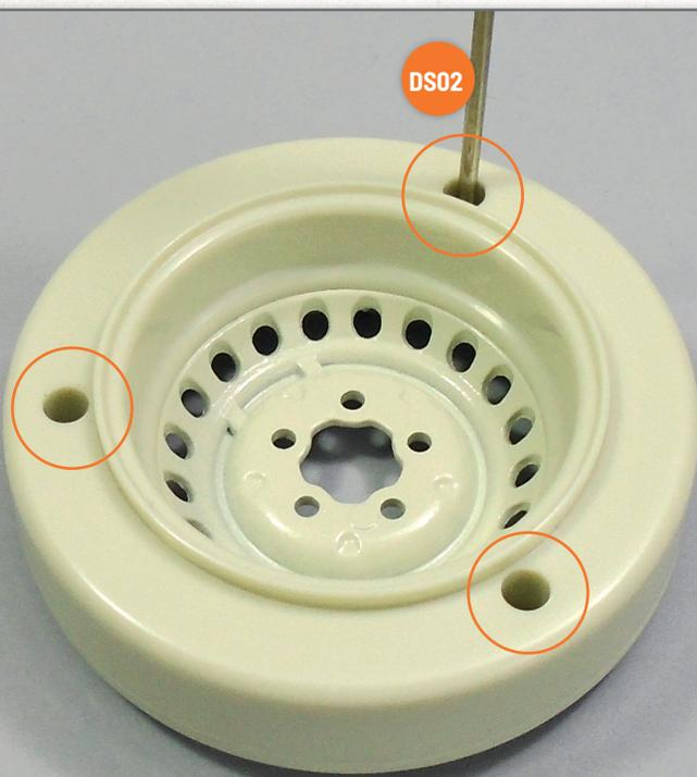
Befestigen Sie die beiden Felgen aneinander, indem Sie drei Schrauben **DS02** in den auf dem Foto durch Kreise markierten Löchern festziehen.
