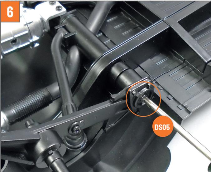
Befestigen Sie die Federstrebe an der Hinterachse, indem Sie eine Schraube **DS05** in dem auf dem Foto gezeigten Loch festziehen.
