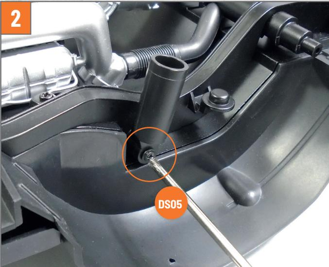
2 Befestigen Sie das Oberteil des Stoßdämpfers mit einer Schraube **DS05** am hinteren Rahmenteil.
