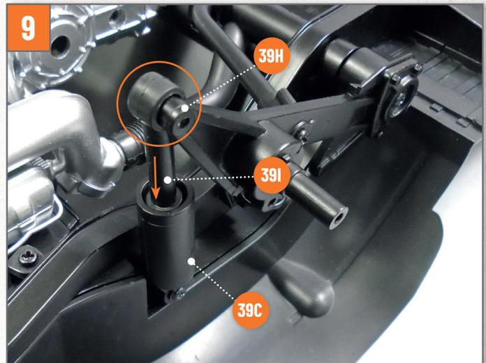
Setzen Sie den Stoßdämpfer **39I** in sein Oberteil **39C** ein und drücken Sie dabei fest auf die Feder. Schieben Sie die Öse des Stoßdämpfers auf den Stift der Federstrebe **39H** und richten Sie die Teile dabei wie auf dem Foto gezeigt aus.
