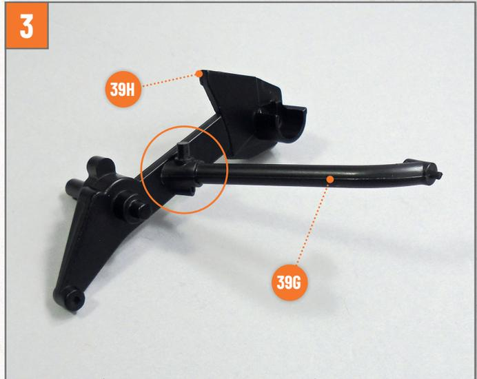
3 Stecken Sie das Ende des Schräglenkers **39G** in das zentrale Loch der Federstrebe **39H**. Schauen Sie sich das Foto genau an, um die Komponenten korrekt auszurichten.
