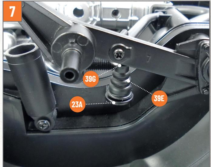
Setzen Sie den breiteren Teil des Anschlaggummis **39E** auf die entsprechende Stelle auf der linken Seite des hinteren Rahmenteils **23A**. Schieben Sie das andere Ende des Anschlaggummis auf den entsprechenden Stift des Schräglenkers **39G**.
