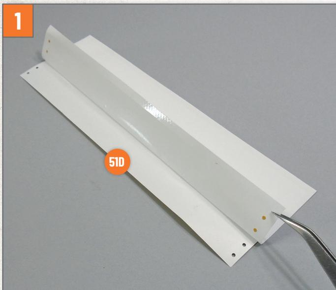
Ziehen Sie die Schutzfolie von der Klebeabdeckung **51D** ab. Verwenden Sie dafür eine Pinzette, wie auf dem Foto gezeigt.
