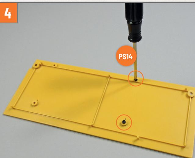
Drehen Sie die Platte um und ziehen Sie zwei Schrauben **PS14** in den auf dem Foto markierten Löchern an, um die Verstärkung zu befestigen.
