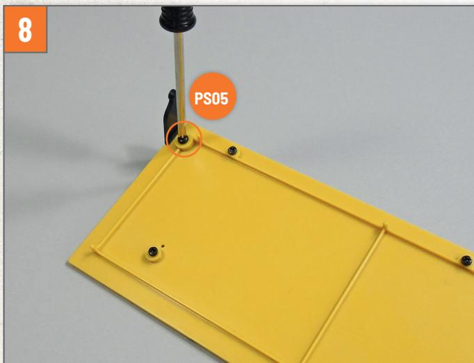
Drehen Sie die Bodenplatte um und ziehen Sie eine Schraube **PS05** fest, um die rechte Halterung an der Baugruppe zu befestigen.
