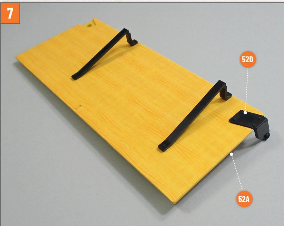
Arbeiten Sie auf der Unterseite der Baugruppe und montieren Sie die rechte Halterung **52D** (mit dem Buchstaben „R“ gekennzeichnet) an der entsprechenden Stelle auf der Bodenplatte **52A**, wie auf dem Foto gezeigt.
