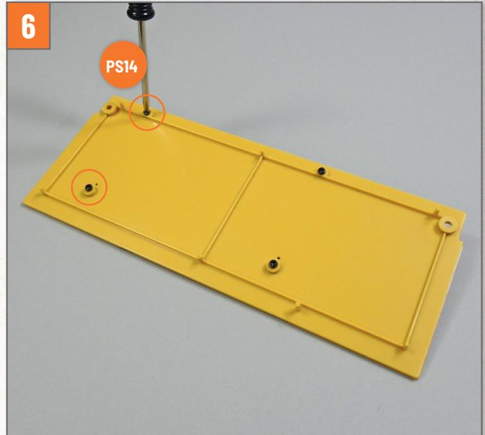
Drehen Sie die Bodenplatte jetzt wieder um und befestigen Sie die Teile aneinander, indem Sie zwei Schrauben **PS14** in den auf dem Foto markierten Löchern festziehen.
