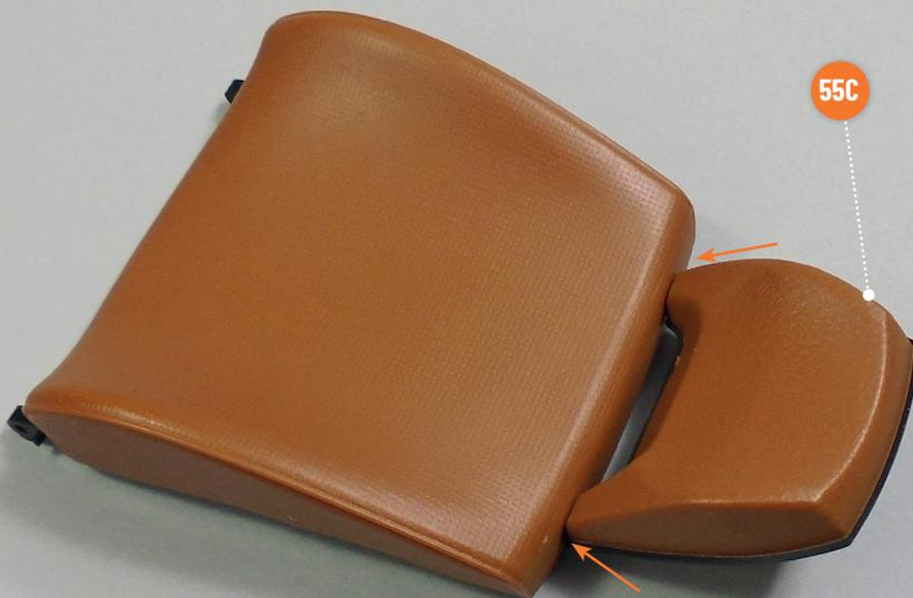
Stecken Sie die beiden Stifte der Kopfstütze **55C** in die entsprechenden Löcher in der Oberkante der Rückenlehne, wie auf dem Foto gezeigt. Achten Sie darauf, dass Sie bei der Montage die Komponenten nicht beschädigen.
