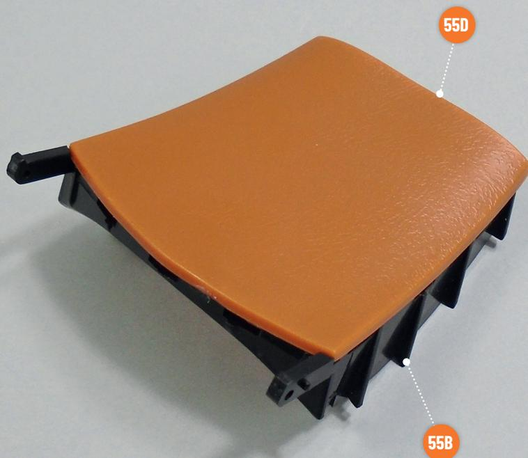
Stecken Sie die Stifte der Rückwand **55D** in die entsprechenden Löcher des Innenrahmens der Rückenlehne **55B** und richten Sie die Teile dabei wie auf dem Foto gezeigt aus.
