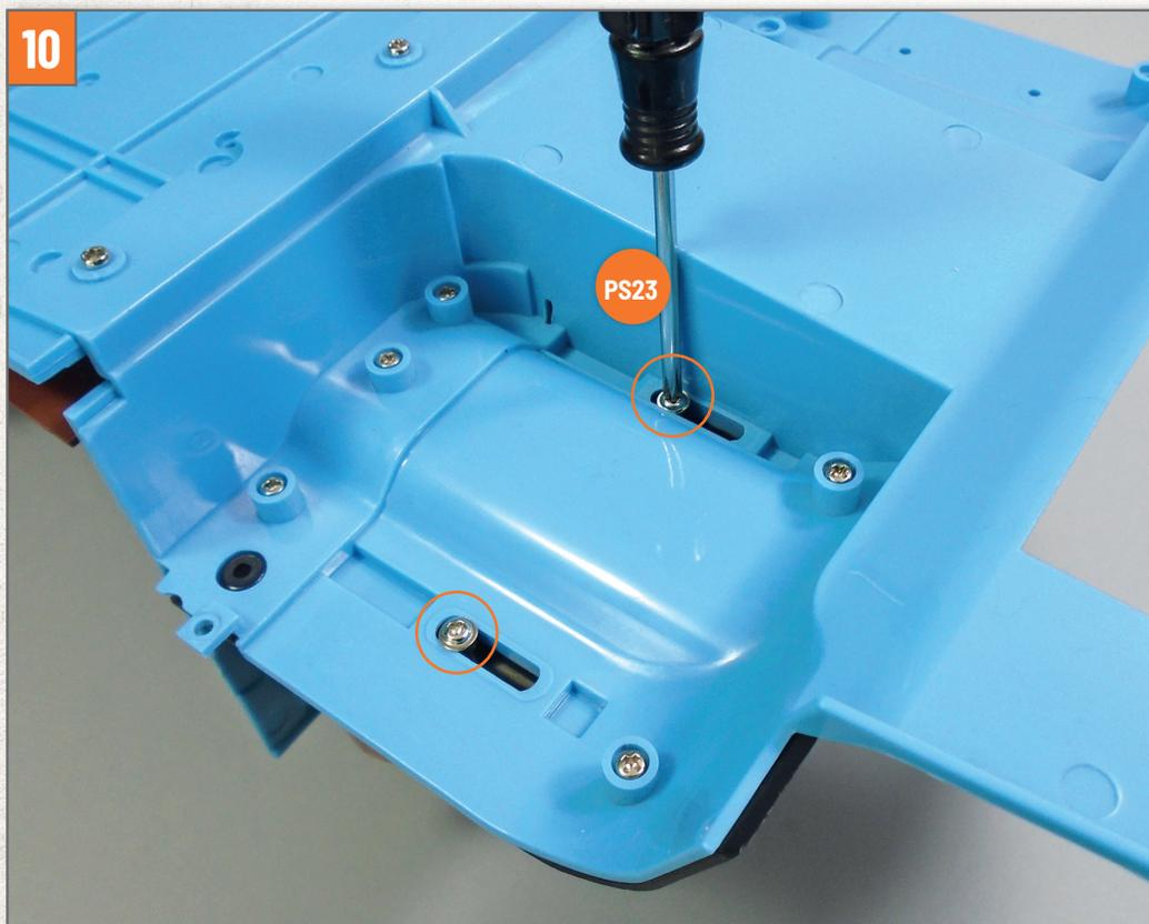
Drehen Sie den Boden um und achten Sie darauf, dass der Fahrersitz nicht aus seiner Halterung rutscht. Ziehen Sie zwei Schrauben **PS23** in den auf dem Foto markierten Löchern fest, um die Komponenten aneinander zu befestigen.
