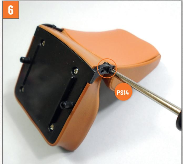
Befestigen Sie zunächst die Komponenten aneinander, indem Sie eine Schraube **PS14** in dem auf dem Foto markierten Loch festziehen.
