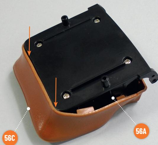
Setzen Sie den vorderen Teil des Innenrahmens **56A** wie auf dem Foto in die Sitzschale des Fahrersitzes **56C** ein.
