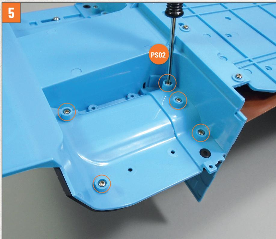
Drehen Sie den Boden um und achten Sie darauf, dass sich die Beifahrersitzplatten nicht lösen. Verbinden Sie die Komponenten miteinander und ziehen Sie fünf Schrauben **PS02** in den auf dem Foto markierten Löchern fest.
