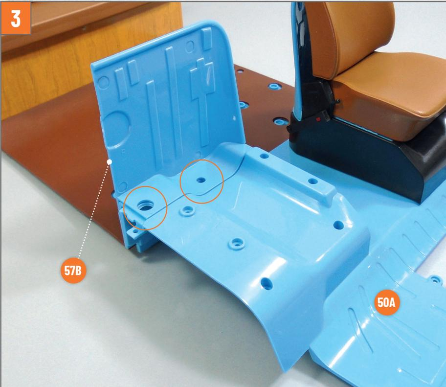
Nehmen Sie den Boden zur Hand, an dem Sie in Bauphase 56 gearbeitet haben. Montieren Sie die Rückplatte des Beifahrersitzes **57B** in der auf dem Foto gezeigten Position und richten Sie ihre Löcher mit denen des Bodens des Fahrgastraums **50A** aus.
