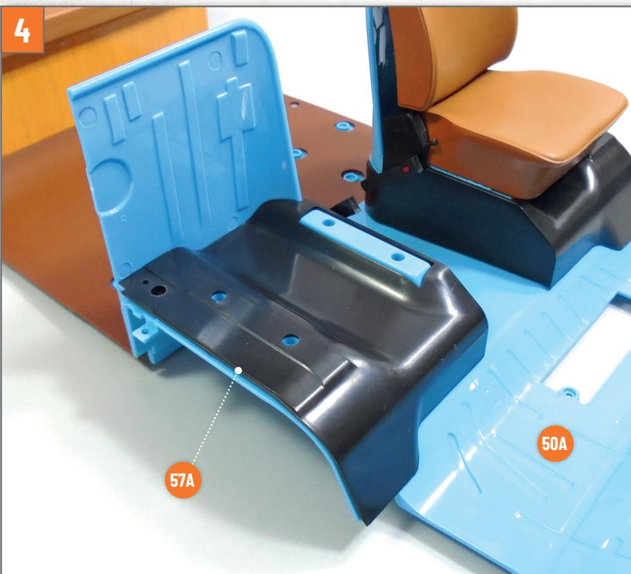
Montieren Sie die Bodenplatte des Beifahrersitzes **57A** auf dem Boden des Fahrgastraums **50A**. Richten Sie die Teile wie auf dem Foto gezeigt aus.
