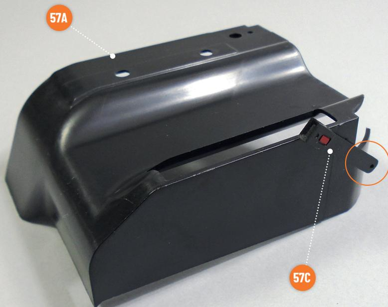
Stecken Sie den Stift am Ende des Sicherheitsgurtschlosses **57C** in das Loch in der Bodenplatte des Beifahrersitzes **57A**, das auf dem Foto mit einem Kreis gekennzeichnet ist. Richten Sie die Teile wie gezeigt aus.
