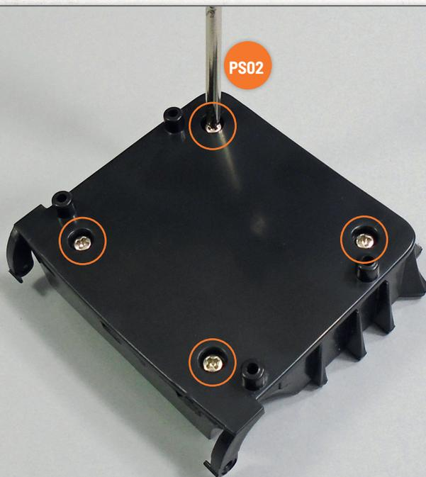
Drehen Sie die Baugruppe um und befestigen Sie die Komponenten, indem Sie vier Schrauben **PS02** in den auf dem Foto markierten Löchern festziehen.
