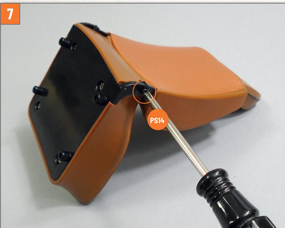
Schließen Sie die Befestigung der Rückenlehne und des Beifahrersitzes ab, indem Sie eine Schraube **PS14** in dem auf dem Foto markierten Loch auf der gegenüberliegenden Seite der Baugruppe festziehen.
