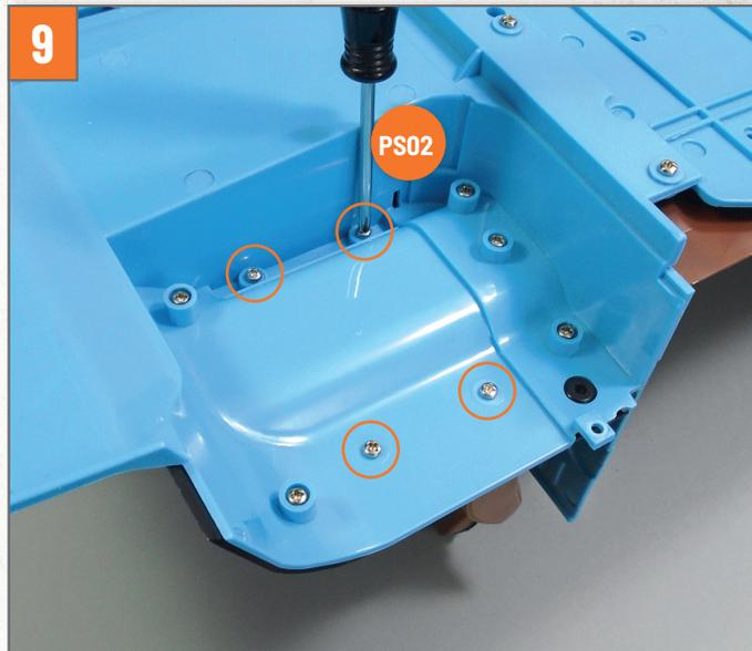
Drehen Sie den Boden um und achten Sie darauf, dass sich der Beifahrersitz nicht löst. Ziehen Sie vier Schrauben **PS02** in den auf dem Foto markierten Löchern fest, um die Komponenten zu fixieren.
