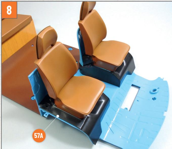
Nehmen Sie den Boden wieder zur Hand, an dem Sie in Bauphase 57 gearbeitet haben. Montieren Sie den Beifahrersitz auf die Bodenplatte **57A** und richten Sie die Teile wie auf dem Foto gezeigt aus.
