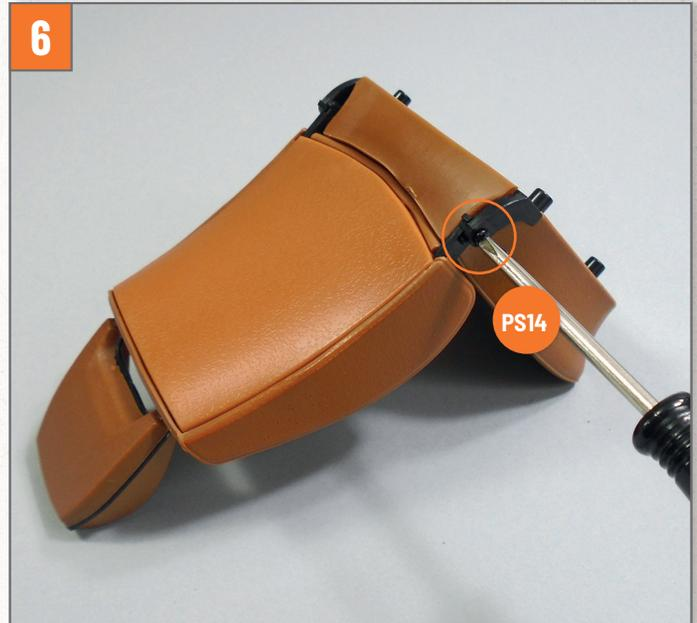
Befestigen Sie die Komponenten zunächst, indem Sie eine Schraube **PS14** in dem auf dem Foto markierten Loch festziehen.
