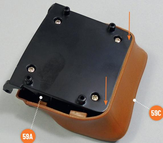
Stecken Sie die Vorderseite des Innenrahmens **59A** in die Polsterung des Beifahrersitzes **59C**, wie auf dem Foto gezeigt.
