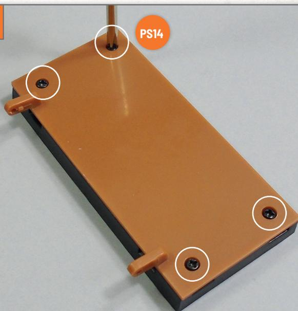
Ziehen Sie vier Schrauben **PS14** in den auf dem Foto mit Kreisen markierten Löchern fest, um die Bauteile zu befestigen.
