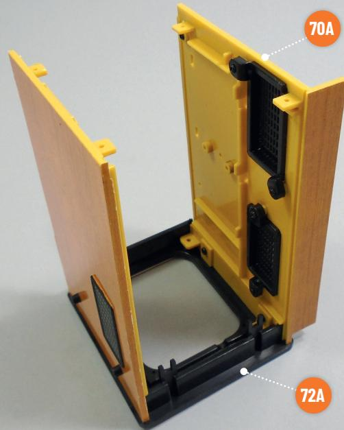
Nehmen Sie die rechte Kühlschrankwand **70A** zur Hand, die Sie in Bauphase 70 montiert haben, und befestigen Sie sie wie auf dem Foto gezeigt am Oberteil des Kühlschranks **72A**.
