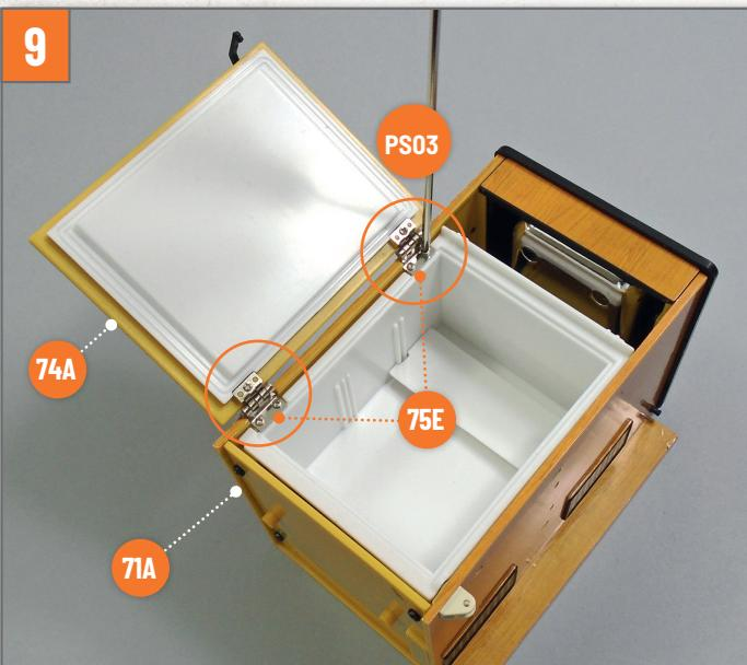
Befestigen Sie jetzt die Tür **74A** an der Schrankwand. Richten Sie die Teile wie abgebildet aus, so dass die Löcher der Scharnierteile 2 **75E** mit denen in der linken Schrankwand **71A** übereinstimmen. Befestigen Sie die Teile mit vier Schrauben **PS03** aneinander.
