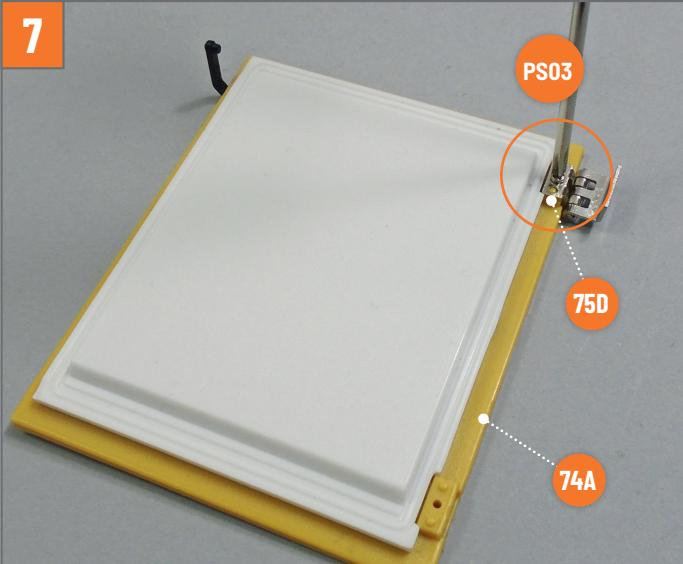
Setzen Sie die Löcher eines Scharnierteils 1 **75D** auf die entsprechende Stelle an der Innenseite von Tür **74A** und richten Sie die Teile wie auf dem Foto gezeigt aus. Befestigen Sie das Scharnier mit einer Schraube **PS03** an der Tür.
