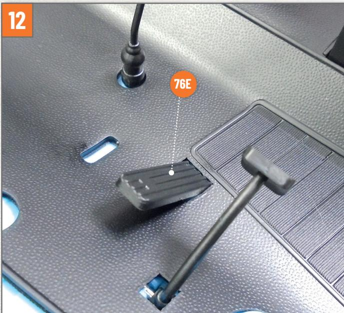
Montieren Sie das Gaspedal **76E** in das dafür vorgesehene Loch im Boden, wie im Foto gezeigt.
