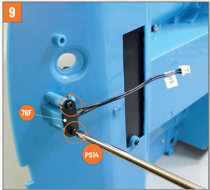
Platzieren Sie die Halterung **76F** wie auf dem Foto gezeigt über dem Schalter. Befestigen Sie sie mit zwei Schrauben **PS14** an der Bodenplatte.
