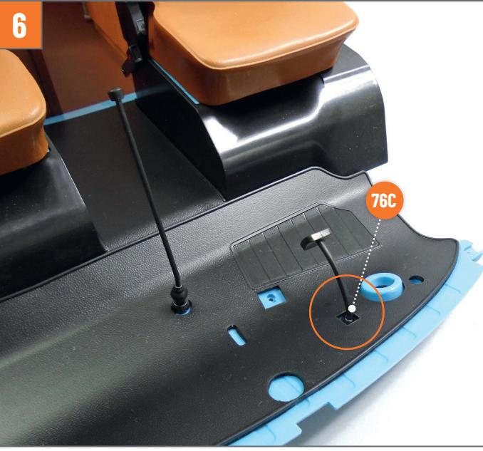
Stecken Sie das Bremspedal **76C** in die im Bild gezeigte Öffnung im Boden.
