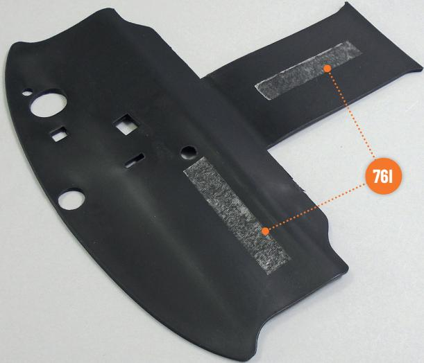
Entfernen Sie die Schutzfolien von den freiliegenden Seiten der beiden Klebestreifen **76I**.
