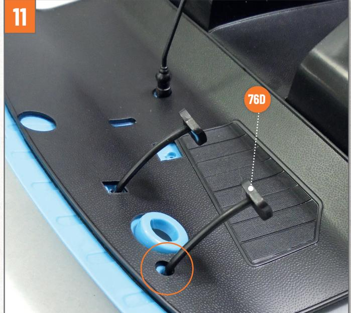
Stecken Sie das Kupplungspedal **76D** in die im Foto gezeigte Öffnung im Boden.
