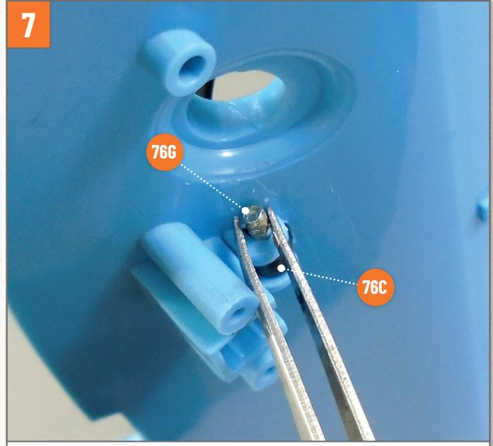
Drehen Sie den Boden um. Achten Sie darauf, dass die Öffnung vom Bremspedal **76C** mit dem Loch im Boden übereinstimmt. Stecken Sie den Stift **76G** in die aneinander ausgerichteten Öffnungen und drücken Sie ihn vollständig hinein.
