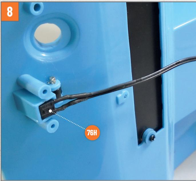
Stecken Sie den Kabelschalter **76H** in die dafür vorgesehene Aussparung an der Unterseite der Bodenplatte und richten Sie die Teile wie auf dem Foto gezeigt aus.
