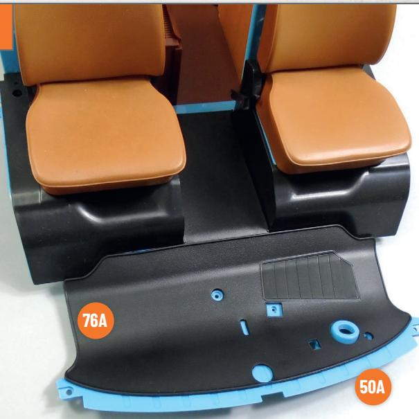
Nehmen Sie den Boden zur Hand, den Sie in Bauphase 75 montiert haben. Legen Sie den Bodenbelag **76A** wie auf dem Foto gezeigt auf den Boden des Fahrgastraums. Achten Sie darauf, dass die Löcher im Bodenbelag mit denen vom Boden übereinstimmen.
