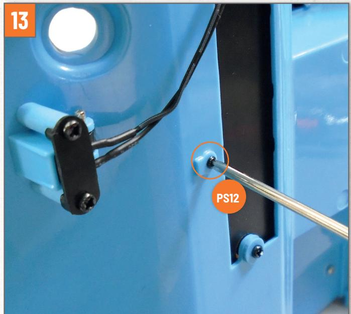
Drehen Sie den Boden um und ziehen Sie eine Schraube **PS12** in der im Foto markierten Bohrung fest, um die Teile aneinander zu befestigen.
