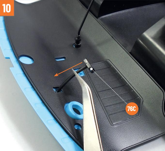
Drehen Sie den Boden um und drücken Sie das Bremspedal **76C** nach vorne, um sicherzustellen, dass der Schalter am unteren Ende des Pedals gedrückt wird.
