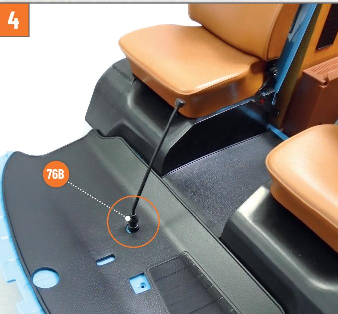
Stecken Sie den Schalthebel **76B** in das auf dem Foto markierte Loch im Boden. Richten Sie die Teile wie abgebildet aus.
