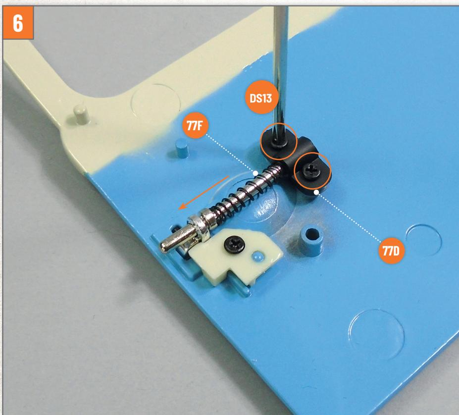
Drücken Sie die Feder **77F** ganz hinein und setzen Sie die Halterung **77D** wie abgebildet auf die beiden Bohrungen. Ziehen Sie zwei Schrauben **DS13** in den markierten Löchern fest, um die Halterung an der Türinnenseite zu befestigen.
