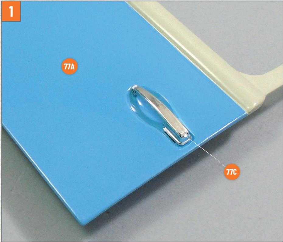
Setzen Sie den Türgriff **77C** wie abgebildet in seine Vorrichtung an der Außenseite der Fahrertür **77A** ein.
