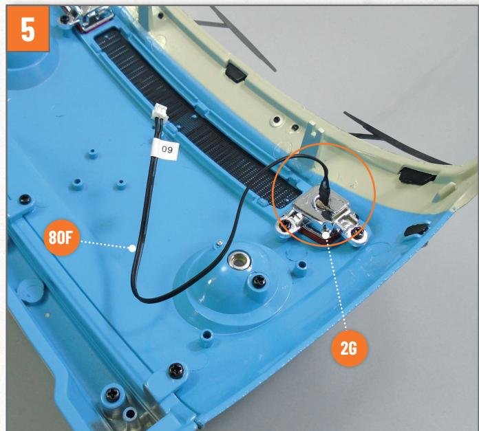
Setzen Sie die LED des Kabels **80F** (mit 09 gekenn- zeichnet) in die Öffnung im rechten Reflektoren- gehäuse **2G** ein.
