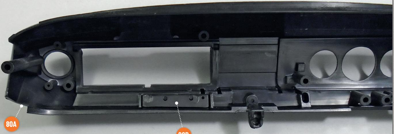
Setzen Sie das Bedienfeld **80B** in die dafür vorgesehene Vertiefung an der Innenseite des Armaturenbretts **80A** ein. Richten Sie die Teile wie auf dem Foto gezeigt aus.
