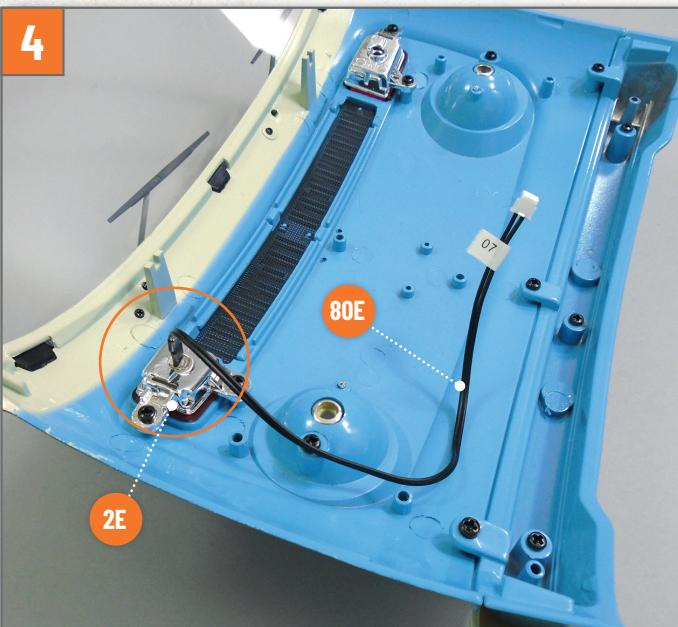
Nehmen Sie die in Bauphase 04 montierte Karosserie- vorderseite zur Hand. Setzen Sie die LED des Kabels **80E** (mit 07 gekennzeichnet) in die Öffnung des linken Reflektorengehäuses **2E** ein.
