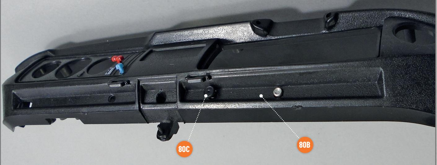
Drehen Sie das Armaturenbrett um. Setzen Sie den mittleren Knopf **80C** in die dafür vorgesehene Öffnung im Bedienfeld **80B** ein.
