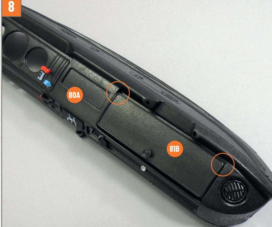
Drehen Sie das Armaturenbrett erneut um. Stecken Sie die seitlichen Stifte der Klappe **81B** in die entsprechenden Öffnungen des Armaturenbretts **80A**, wie im Foto gezeigt.
