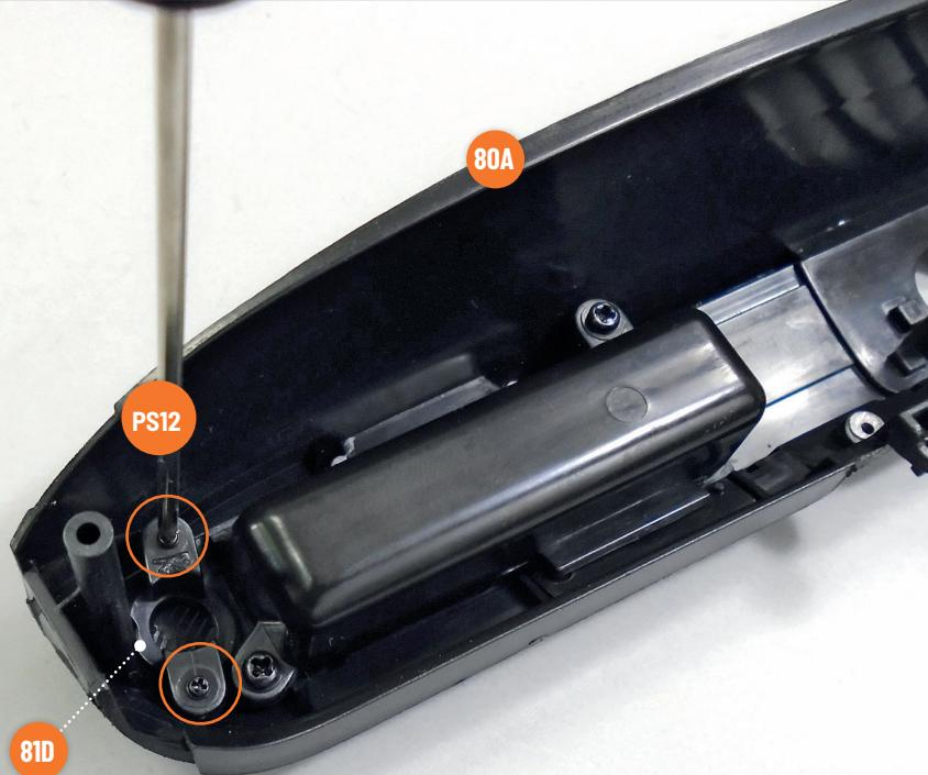
Setzen Sie das rechte Lüftungsgitter **81D** (mit dem Buchstaben „R“ gekennzeichnet) in die entsprechende Vertiefung auf der Innenseite des Armaturenbretts **80A** ein. Befestigen Sie die Teile mit zwei Schrauben **PS12**.
