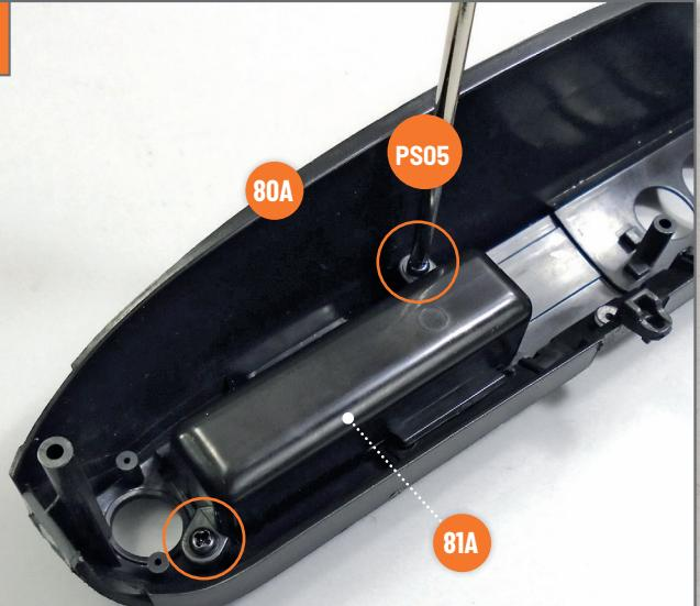
Nehmen Sie das in Bauphase 80 montierte Armaturenbrett zur Hand. Setzen Sie das Handschuhfach **81A** in die entsprechende Stelle auf der Innenseite des Armaturenbretts **80A** ein und befestigen Sie die Teile mit zwei Schrauben **PS05**.
