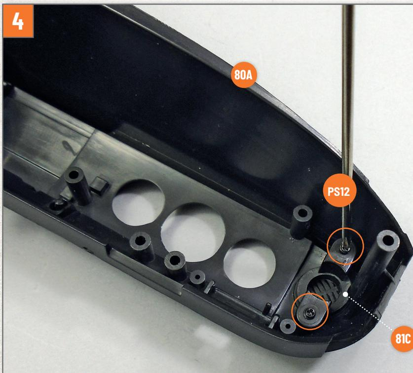
Setzen Sie das linke Lüftungsgitter **81C** (mit dem Buchstaben „L“ gekennzeichnet) in die entsprechende Vertiefung auf der Innenseite des Armaturenbretts **80A** ein. Befestigen Sie die Teile mit zwei Schrauben **PS12**.
