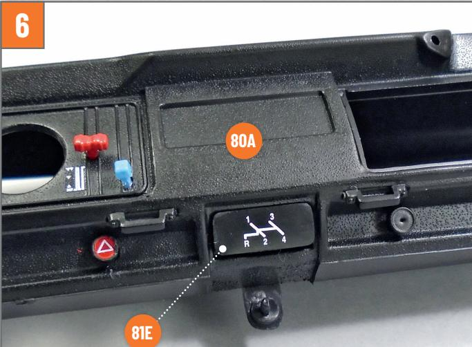
Drehen Sie die Baugruppe um und setzen Sie die Blende mit Schaltschema **81E** in die dafür vorgesehene Aussparung in der Mitte des Armaturenbretts **80A** ein. Folgen Sie bei der Ausrichtung der Teile der Abbildung.
