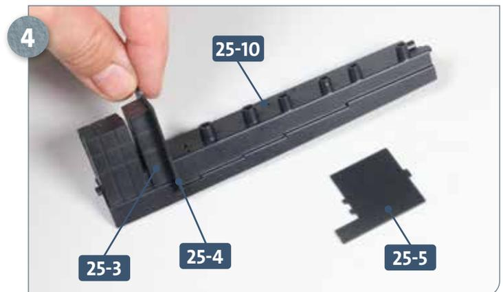
Kleben Sie die Munitionskisten **25-3/25-4** in den beiden nächsten Schlitzern der Installationsschiene **25-10** fest. Legen Sie die Trennwand **25-5** bereit.
