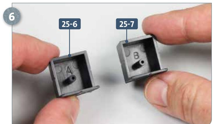
Als Nächstes sind die Batteriezellen **25-6** und **25-7** an der Reihe. Sie lassen sich durch die Markierung an der Unterseite unterscheiden: **25-6** trägt ein „A“, **25-7** ein „B“.
