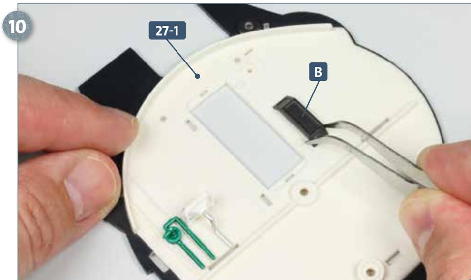
Trennen Sie den Heizkörper **B** aus dem Rahmen **27-2**. Geben Sie etwas Klebstoff auf die beiden Zapfen an der Rückseite des Heizkörpers und fügen Sie diese in die Löcher im vorderen Schott **27-1** ein.
