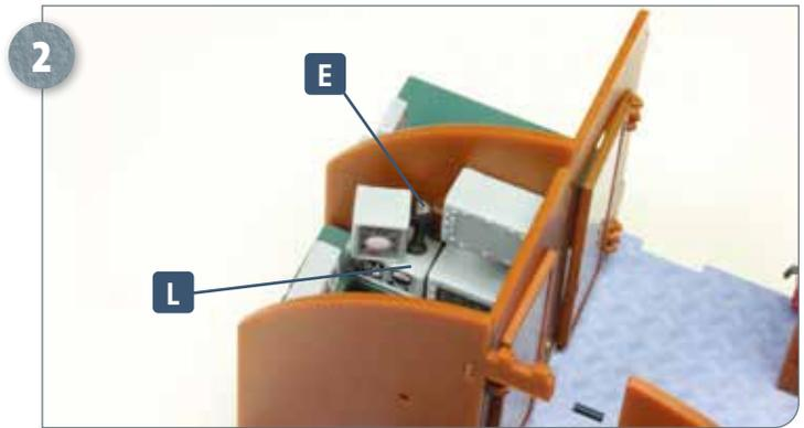
Stellen Sie die zweite Sektion so auf Ihre Arbeitsplatte, dass Sie Zugriff auf den Horchraum haben. Geben Sie etwas Klebstoff auf den Zapfen an der Unterseite vom Mikrofon E und kleben Sie es im Schlitz von Teil L (aus Ausgabe 23) fest.
