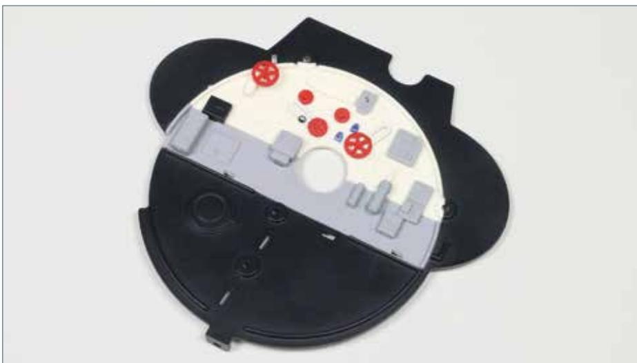
**Das achtere Zentraleschott hat deutlich an Farbe gewonnen: Sämtliche Anbauteile sind an ihm befestigt.**
