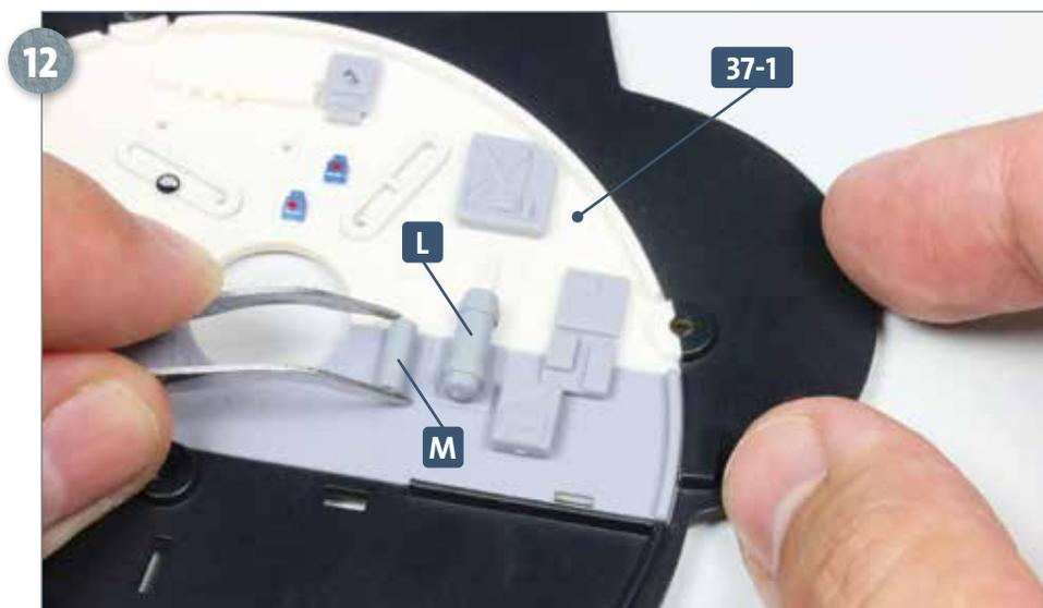
Im rechten Bereich des Zentraleschotts **37-1** finden die beiden Teile **L** und **M** ihren Platz. Versehen Sie deren Zapfen jeweils mit etwas Sekundenkleber und fügen Sie sie in die entsprechenden Schlitz des Schotts ein.
