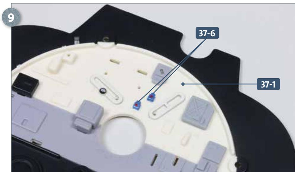
Verfahren Sie genauso mit dem zweiten Lichtschalter **37-6** und kleben Sie diesen ebenfalls am Zentraleschott **37-1** fest. Das Foto zeigt die beiden montierten Schalter.
