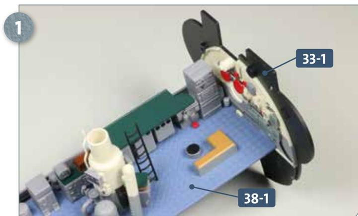
Geben Sie etwas Sekundenkleber auf die beiden Zapfen an der Vorderseite des Zentralebodens **38-1** und fügen Sie diese in die Schlitz des vorderen Zentraleschotts **33-1** ein.
