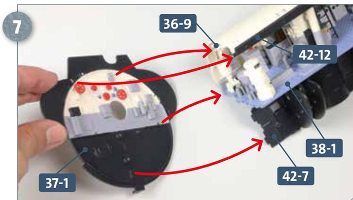
Wechsel ans andere Ende der Zentrale: Die Schlitz am achteren Zentraleschott 37-1 sollen die mit Kleber versehenen Zapfen der Leitung 36-9, der Leiste 42-12, des Zentralebodens 38-1 sowie der Tauchzelle 42-7 aufnehmen, wie es die Pfeile andeuten.
