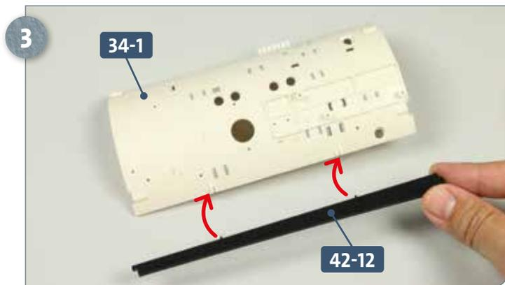
Stellen Sie die Zentraledecke **34-1** auf den Kopf. Nehmen Sie die Abdeckungsleiste **42-12**, geben Sie etwas Klebstoff auf deren zwei Zapfen und führen Sie diese zu den Aufnahmen an der Decke.
