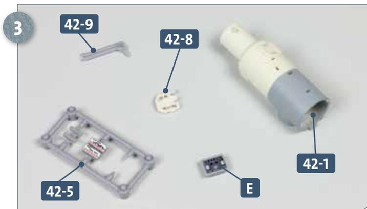
3 Legen Sie den Angriffsehrschacht 42-1, die Anbauteile 42-8 und 42-9 sowie den Rahmen 42-5 bereit. Trennen Sie aus dem Rahmen das Teil E heraus.
