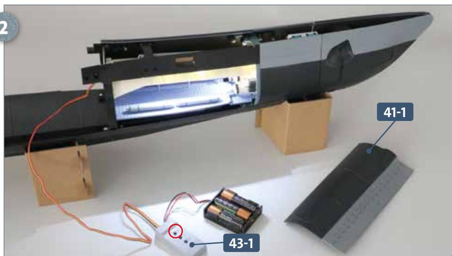
Entfernen Sie den abnehmbaren Rumpfabschnitt **41-1** von der Rumpfstruktur. Drücken Sie den obersten Knopf „S-1“ der Testplatine (links, eingekreist), leuchten die weißen LEDs im Bugraum auf. Bei erneutem Knopfdruck erlöschen sie wieder. Abermaliges Drücken lässt die rote LED aufscheinen (Detailbild unten). Beim vierten Drücken geht die LED wieder aus. Das nächste Drücken des Knopfs „S-1“ startet den Funktionszyklus von Neuem.
