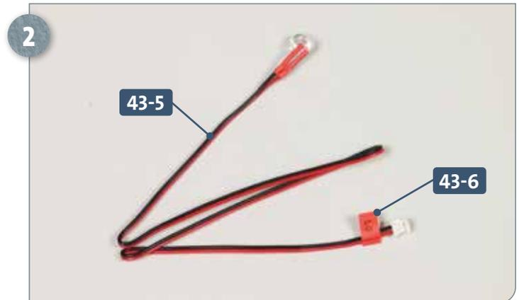
Bringen Sie die Kabelmarkierung **43-6** mit dem Aufdruck „L-2“ etwa 8 mm vom Stecker des Kabels entfernt an.
