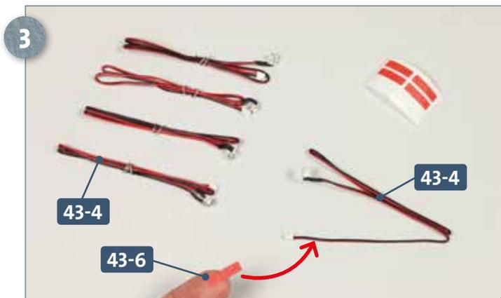
Legen Sie die fünf Kabel **43-4** mit weißer LED (und schwarzer Manschette) bereit. Lösen Sie eine der Kabelmarkierungen **43-6** mit dem Aufdruck „L-1“ von der Trägerfolie und führen Sie sie zum Stecker-Ende eines der Kabel **43-4**, wie es der Pfeil andeutet.
