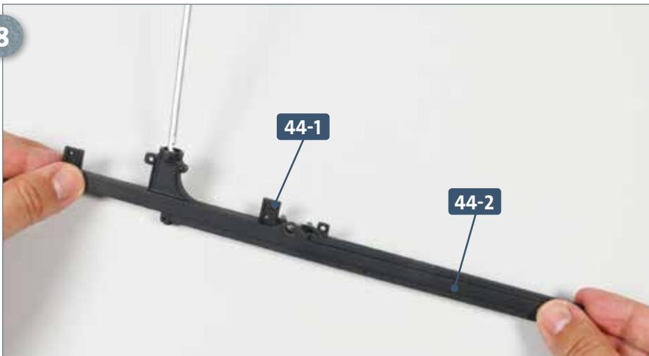
Halten Sie die Feder-Sehrohr-Baugruppe in Position und setzen Sie das Vorderteil der Führung **44-1** auf das Hinterteil **44-2**, wie es das Foto zeigt.
