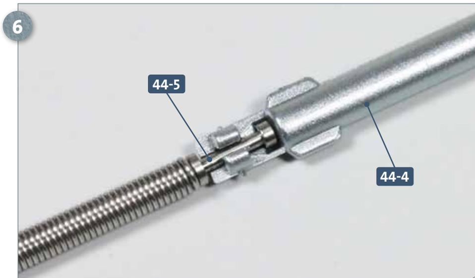
Befestigen Sie den Verbinder **44-5** am Angriffssehrohr **44-4**, indem Sie seinen Stift kräftig in die Aufnahme am Sehrohr hineindrücken. Die beiden Bauteile sind somit drehbar miteinander verbunden.
