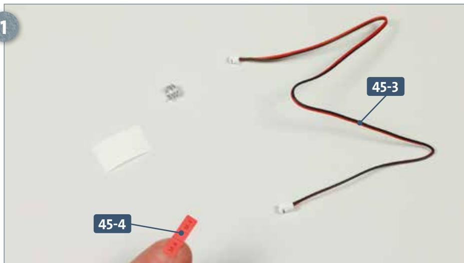
Legen Sie das Kabel **45-3** bereit und entfernen Sie dessen Umwicklung. Lösen Sie die Kabelmarkierung **45-4** von ihrer Trägerfolie, wie abgebildet.
