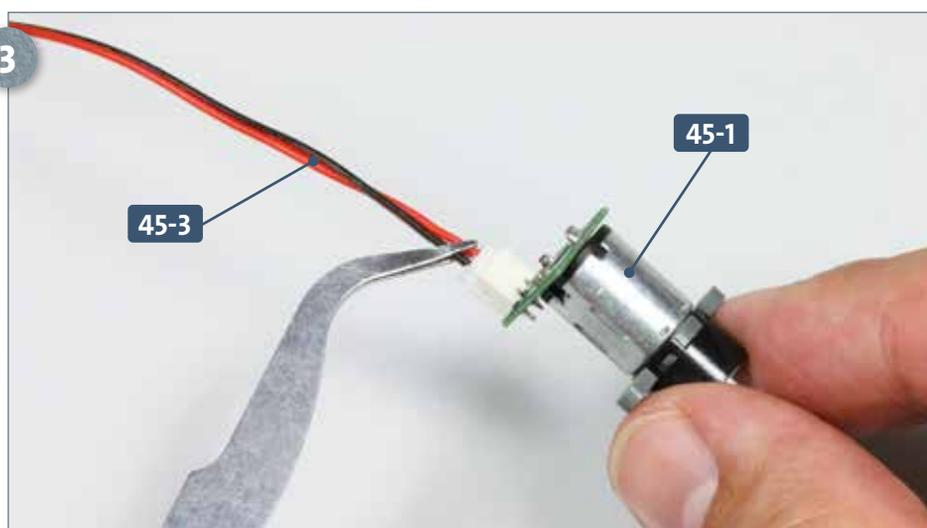
Fügen Sie das markierungslose Ende des Kabels **45-3** in den Port auf der Platine des Motors **45-1** ein.
