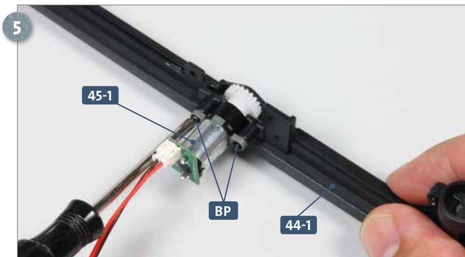
Fixieren Sie die Laschen am Motor **45-1** mit zwei Schrauben **BP** an der Führung **44-1**.
