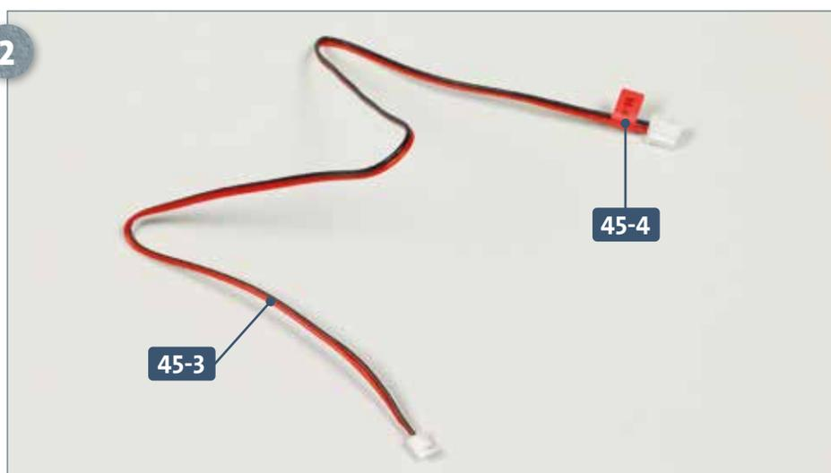
Bringen Sie die Kabelmarkierung **45-4** mit einem Abstand von rund 8 mm zu einem Stecker am Kabel **45-3** an.
