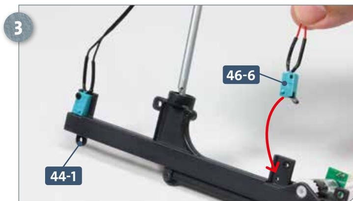
Nehmen Sie den Endschalter mit dem roten Kabel **46-6** und führen Sie ihn zu der Aufnahme der Führung **44-1**, auf die der Pfeil weist.
