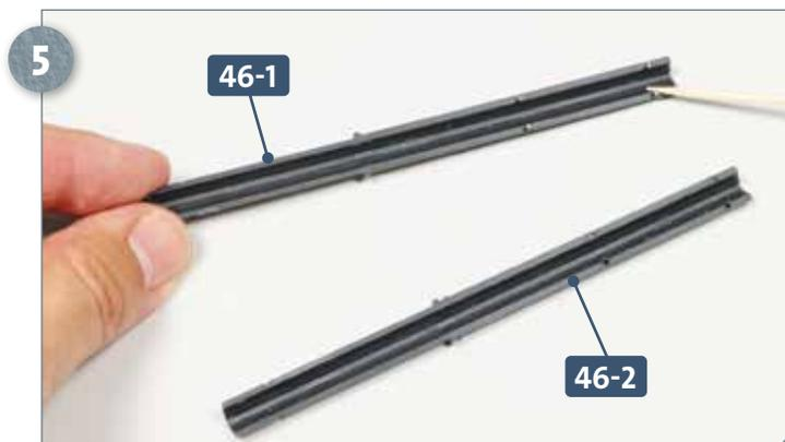
Legen Sie die beiden Hälften des Schachts des Angriffssehrohrs **46-1** und **46-2** bereit. Versehen Sie die Zapfen an den Innenseiten von **46-1** mit etwas Sekundenkleber.
