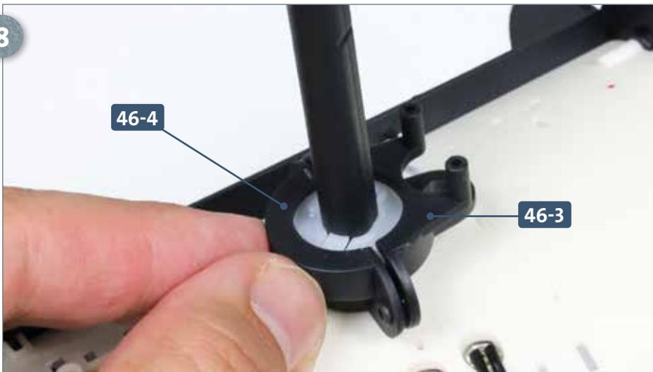
Nehmen Sie die vordere Hälfte der Motorhalterung **46-4** und setzen Sie sie gegen die hintere Hälfte **46-3**.
