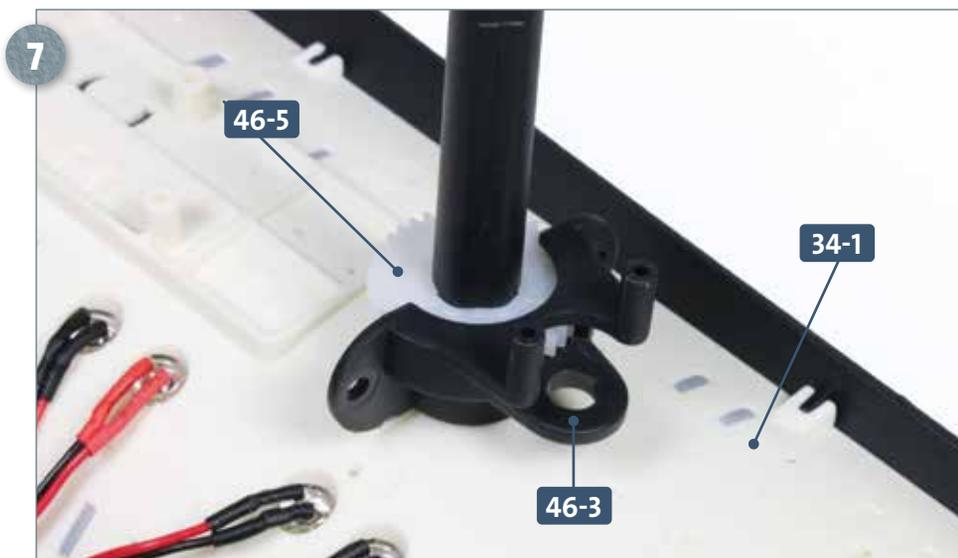
Setzen Sie die hintere Hälfte der Motorhalterung **46-3** am Zahnrad **46-5** auf. Der Zapfen an der Innenseite der Halterung greift in das Loch der Vorwölbung der Zentraledecke **34-1**.
