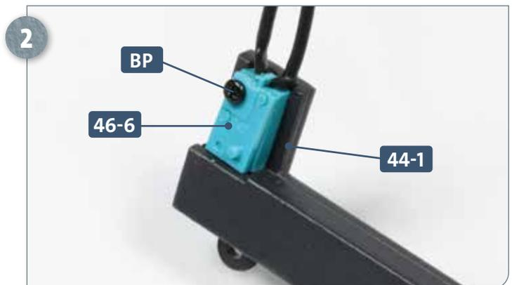
Befestigen Sie den Endschalter mit dem schwarzen Kabel **46-6** mit einer Schraube **BP** an der Führung **44-1**.
